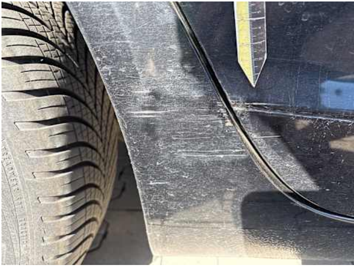
Seitenteil hinten rechts (Kratzer, Unsachgemäß instand gesetzt)
