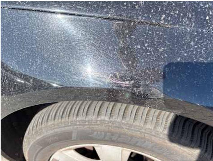
Kotflügel vorne rechts (Lackschaden, Unsachgemäß instand gesetzt)
