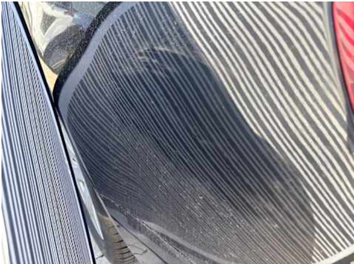
Seitenteil hinten links (Lackschaden)
