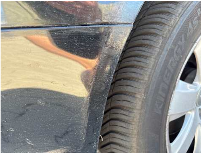
Stoßstange vorne (Lackschaden, Unsachgemäß instand gesetzt)
