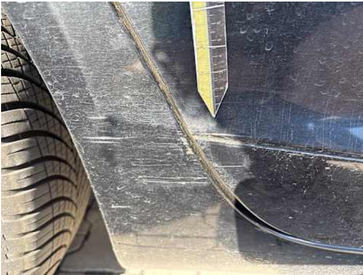
Türe hinten rechts (Kratzer, Unsachgemäß instand gesetzt)
