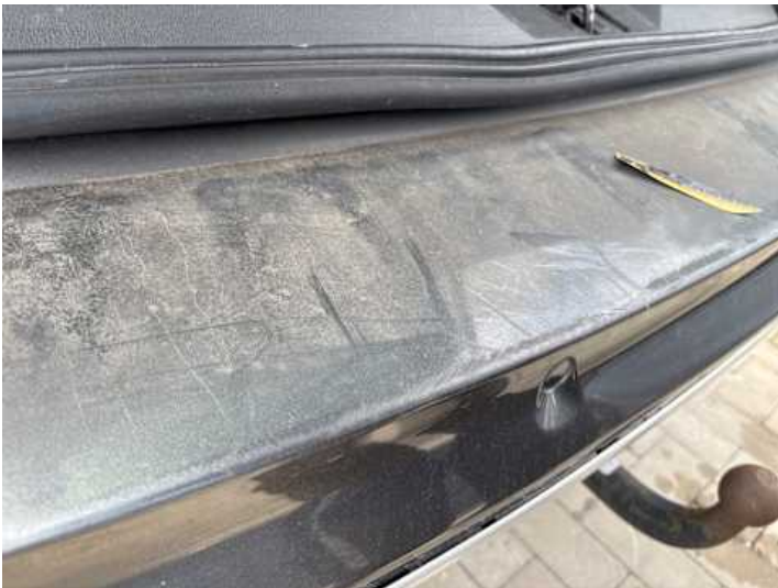
Stoßstange hinten (Lackschaden, Kratzer)
