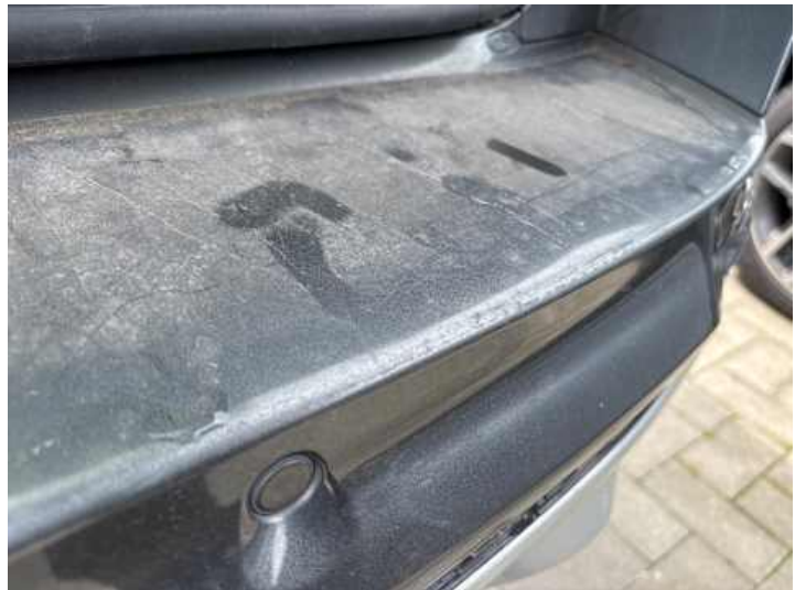
Stoßstange hinten (Lackschaden, Kratzer)
