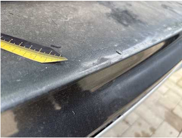
Stoßstange hinten (Lackschaden, Kratzer)
