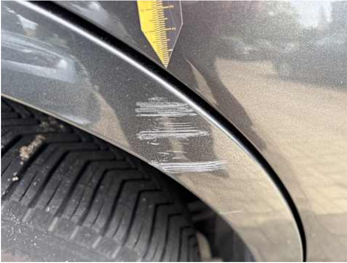
Seitenteil hinten rechts (Kratzer, Lackschaden)
