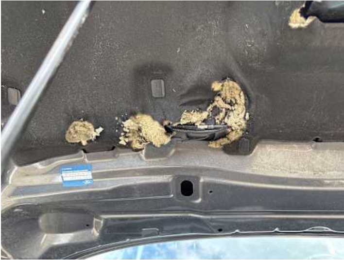
Motorhaube (Anderer Schaden): Motordämmung beschädigt
