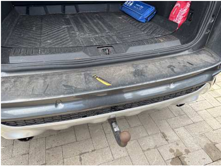
Stoßstange hinten (Lackschaden, Kratzer)
