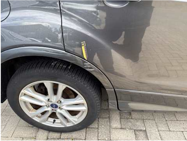
Seitenteil hinten rechts (Kratzer, Lackschaden)
