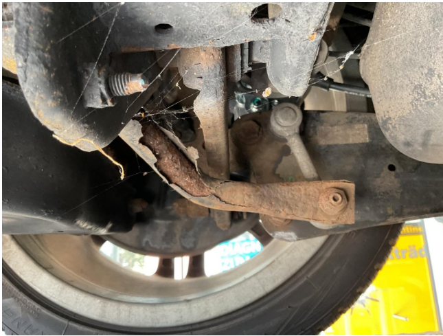
Stabilisator hinten korrosionsgeschwächt
