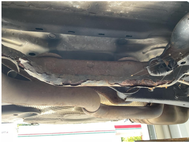
Stabilisator hinten korrosionsgeschwächt
