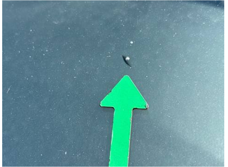
Windschutzscheibe (Riss/Bruch, Steinschlag)
