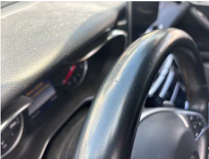
Innenraum (Verschleiß, Verschmutzung)
