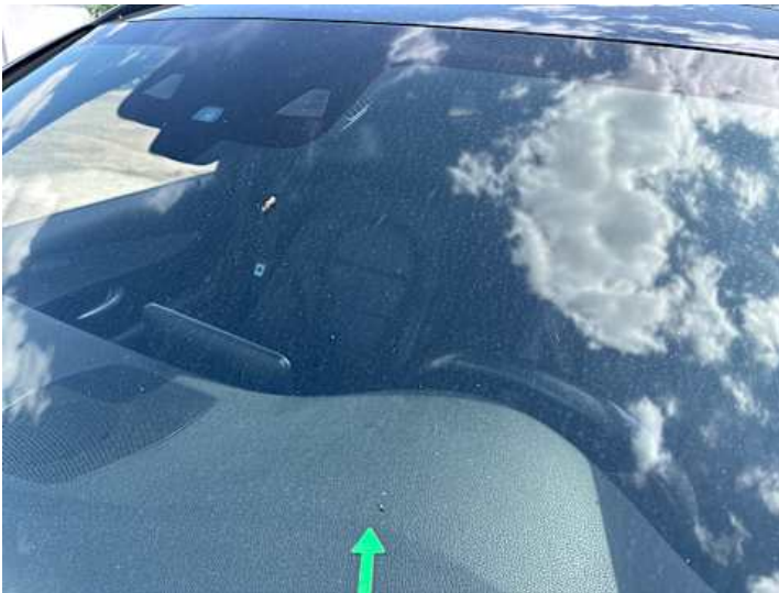
Windschutzscheibe (Riss/Bruch, Steinschlag)
