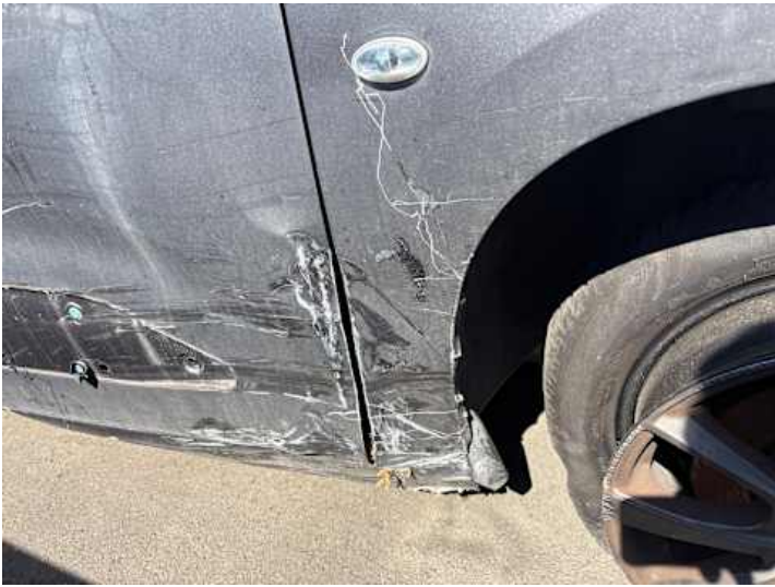
Kotflügel vorne rechts (Verformung, Kratzer)
