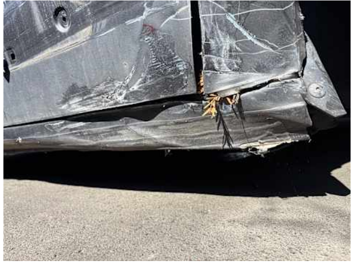
Schweller rechts (Verformung)
