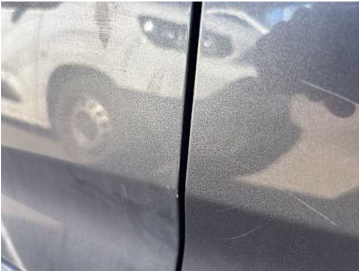
Fahrtür (Kratzer, Delle)
