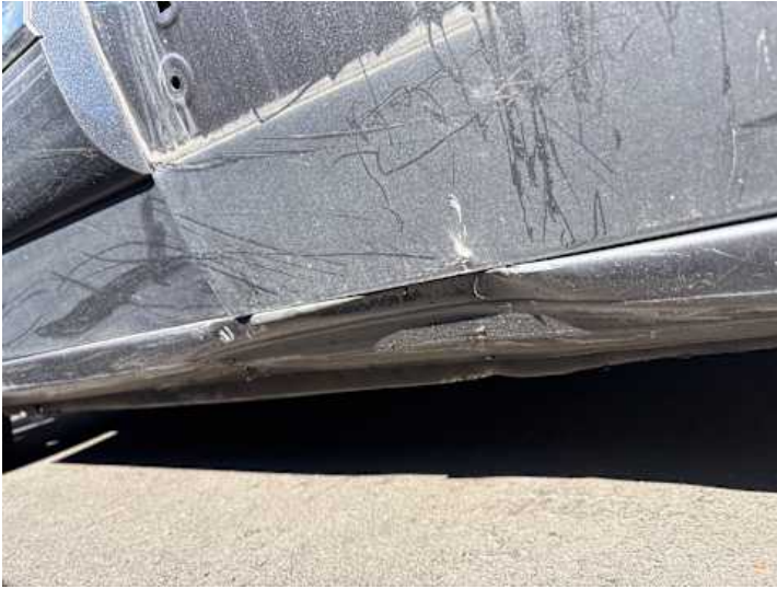
Schweller rechts (Verformung)
