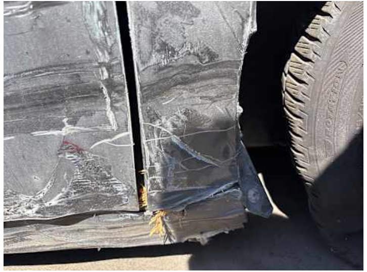
Kotflügel vorne rechts (Verformung, Kratzer)
