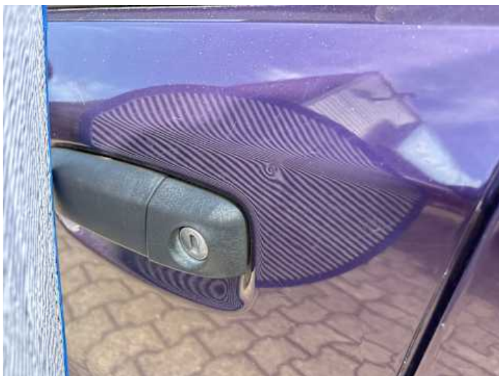
Fahrtür (Kratzer, Delle)
