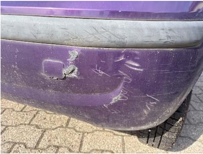
Stoßstange hinten (Kratzer, Verformung)
