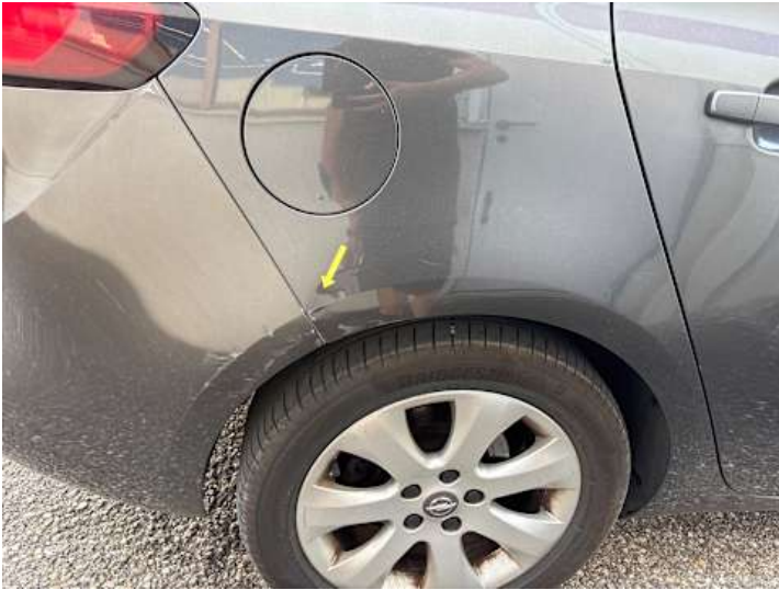
Seitenteil hinten rechts (Verformung, Lackschaden)
