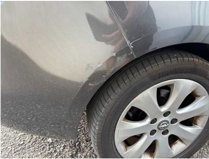
Stoßstange hinten (Kratzer, Lackschaden, Verformung, Spaltmaße ungenau)
