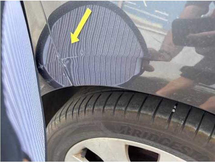
Seitenteil hinten rechts (Verformung, Lackschaden)
