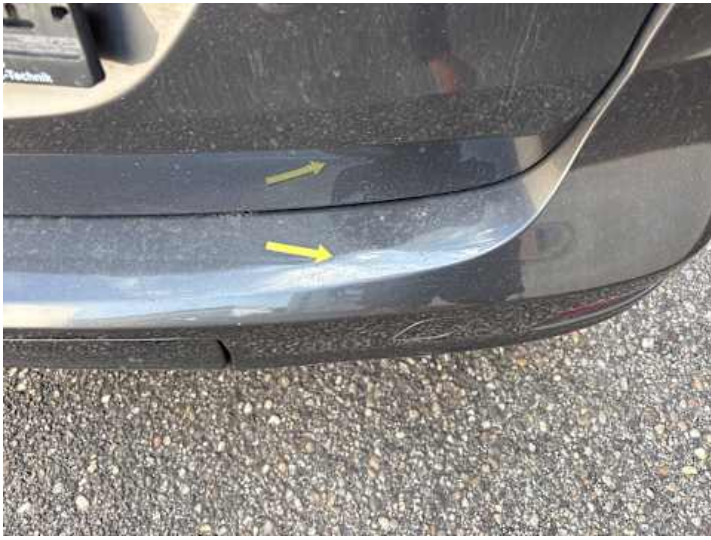
Stoßstange hinten (Kratzer, Lackschaden, Verformung, Spaltmaße ungenau)
