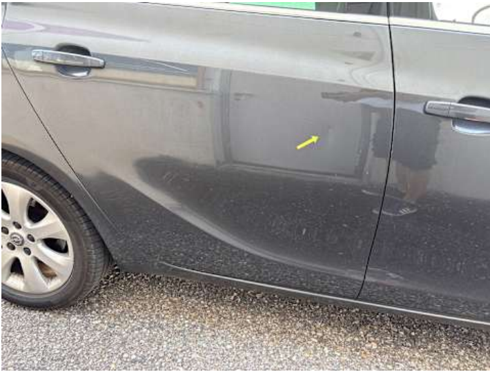
Türe hinten rechts (Delle, Kratzer, Lackschaden)
