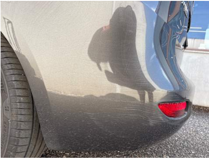
Stoßstange hinten (Kratzer, Lackschaden, Verformung, Spaltmaße ungenau)
