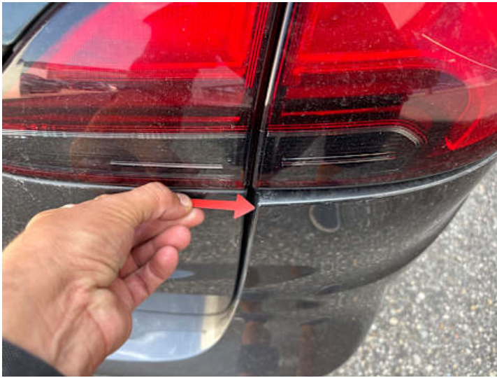
Stoßstange hinten (Kratzer, Lackschaden, Verformung, Spaltmaße ungenau)
