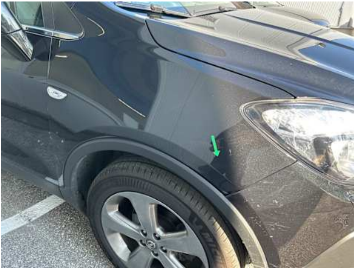
Kotflügel vorne rechts (Verformung)
