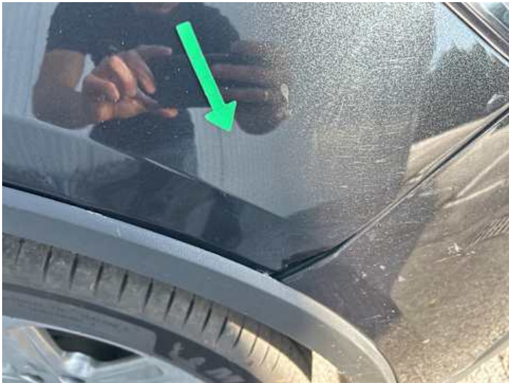
Kotflügel vorne rechts (Verformung)
