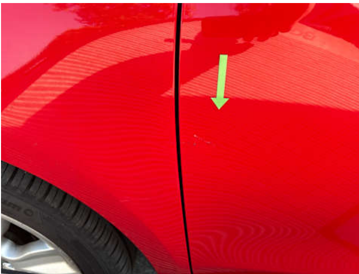
Fahrtür (Kratzer, Delle)
