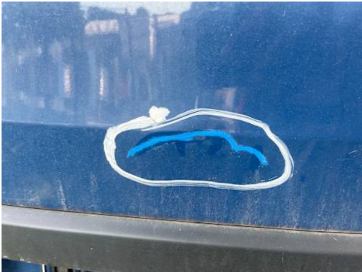
Heckklappe (Lackschaden, Kratzer, Unsachgemäß instand gesetzt)
