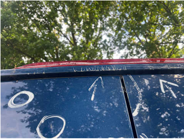
Dach (Lackschaden, Kratzer)
