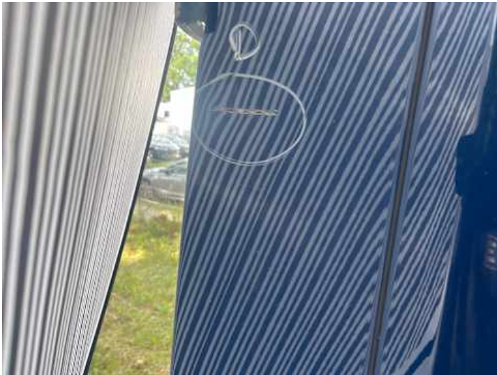
Seitenteil hinten rechts (Delle)
