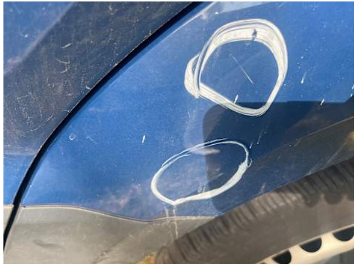
Kotflügel vorne rechts (Kratzer, Lackschaden)
