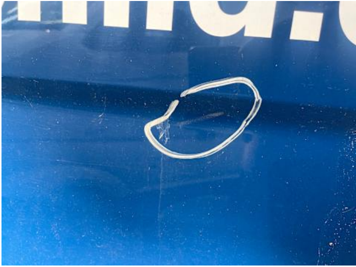
Seitenteil hinten rechts (Kratzer, Lackschaden)
