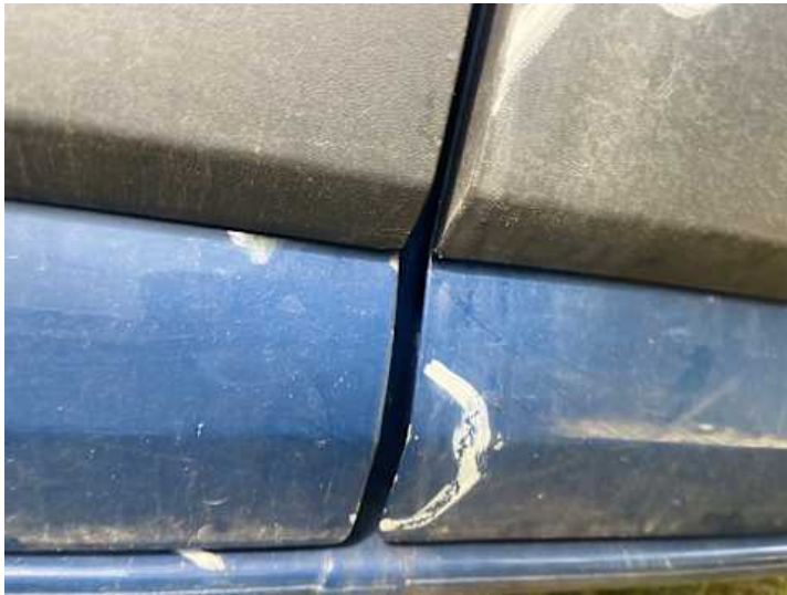
Beifahrertür (Kratzer, Lackschaden)
