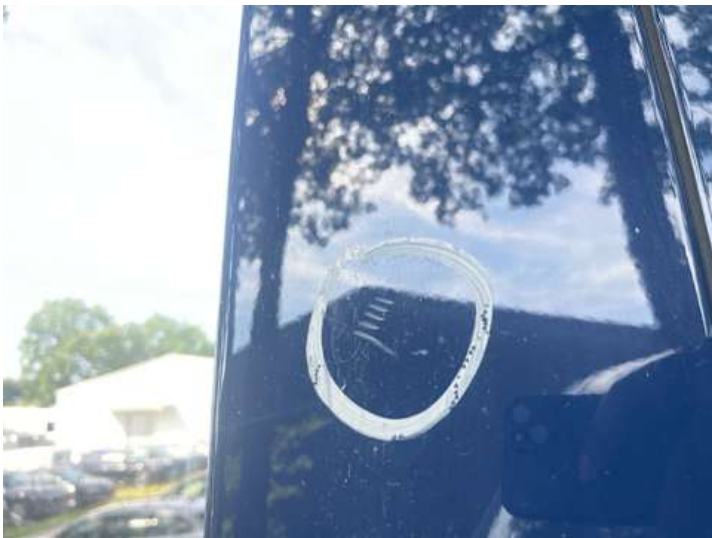
Seitenteil hinten rechts (Kratzer, Lackschaden)
