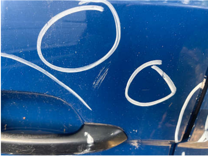
Türe hinten rechts (Kratzer, Lackschaden)
