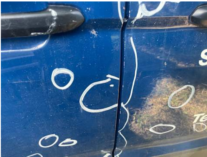
Beifahrertür (Kratzer, Lackschaden)
