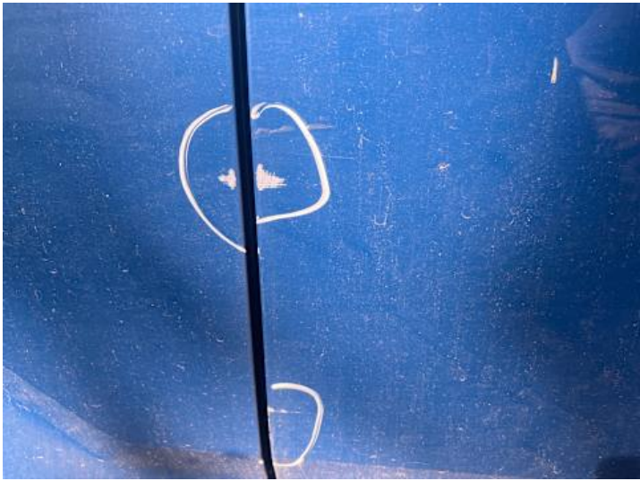
Türe hinten rechts (Kratzer, Lackschaden)
