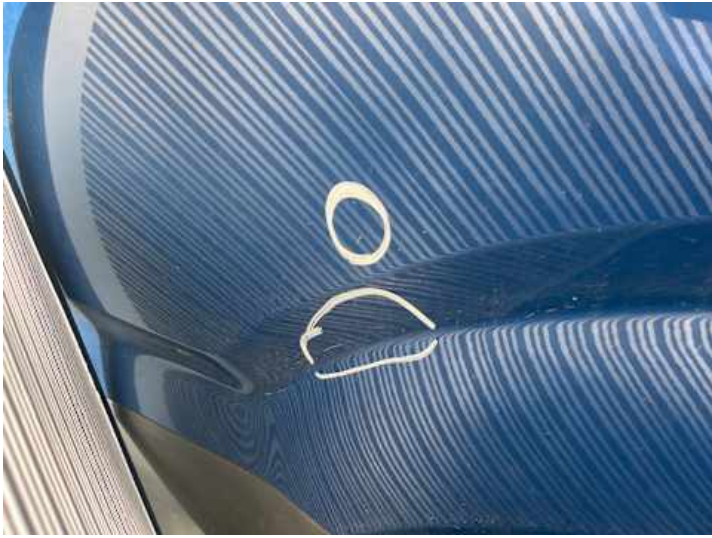
Seitenteil hinten rechts (Delle)
