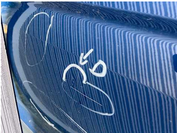
Seitenteil hinten links (Delle)
