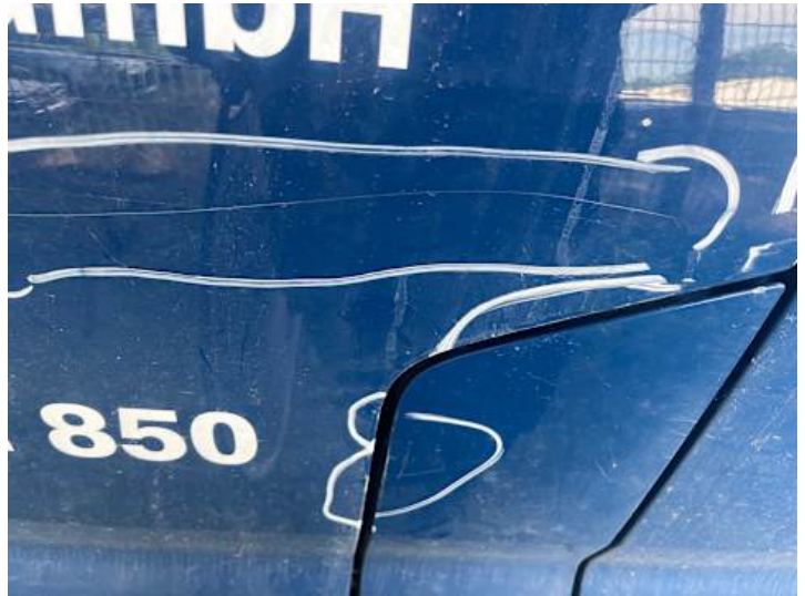
Fahrtür (Kratzer, Lackschaden)
