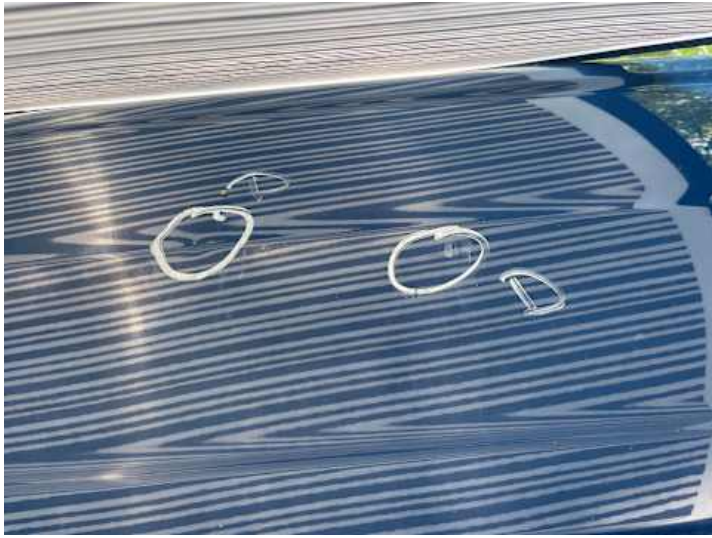
Seitenteil hinten rechts (Delle)
