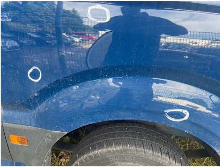
Seitenteil hinten links (Kratzer, Lackschaden)
