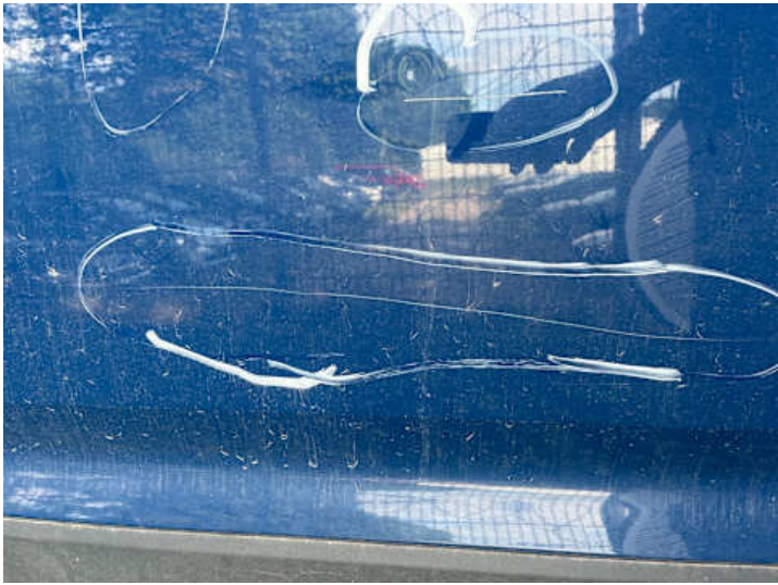
Seitenteil hinten links (Kratzer, Lackschaden)
