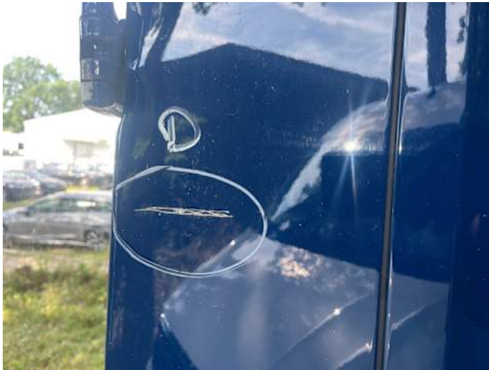
Seitenteil hinten rechts (Kratzer, Lackschaden)
