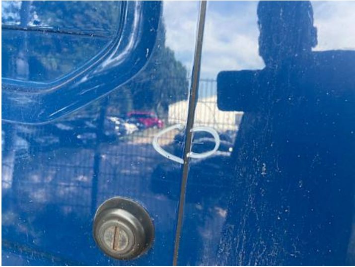
Seitenteil hinten links (Kratzer, Lackschaden)
