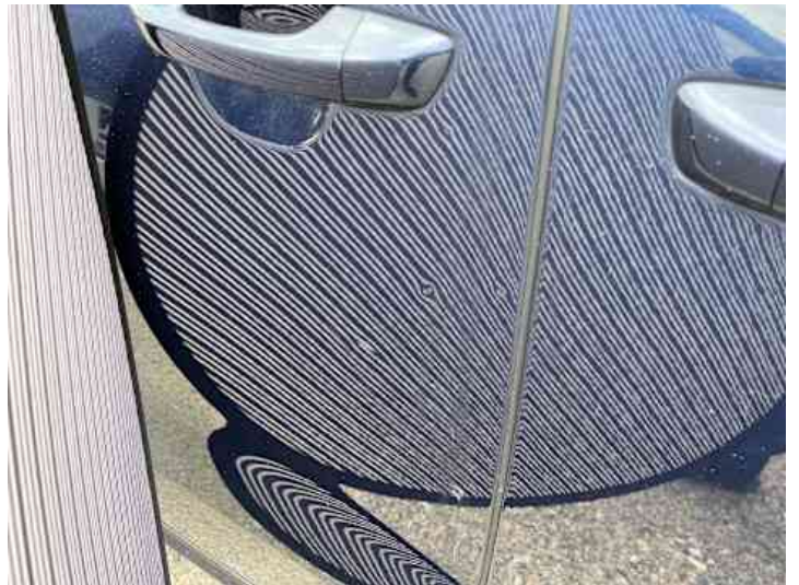
Türe hinten rechts (Delle)
