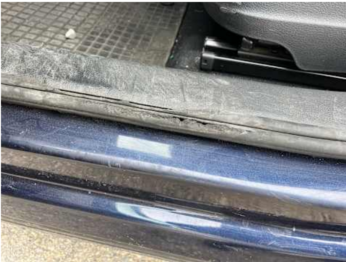
Schweller links (Riss/Bruch)
