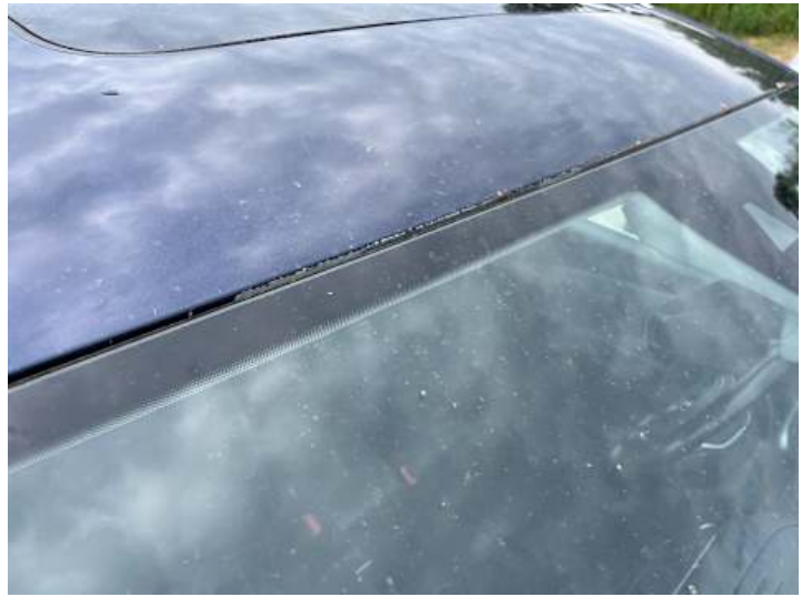
Dach (Lackschaden, Rost)
