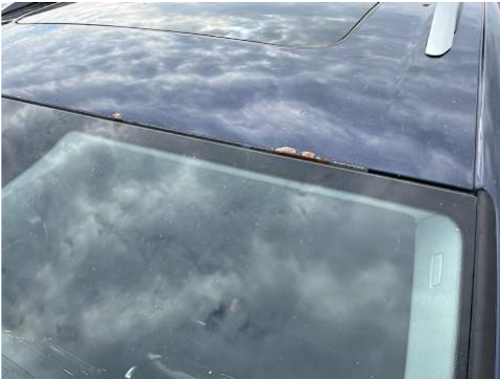
Dach (Lackschaden, Rost)
