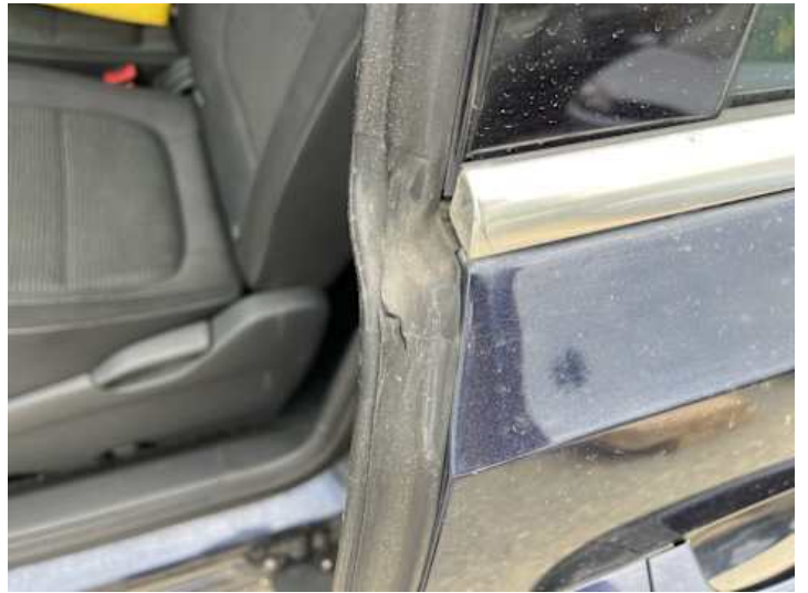
Türe hinten links (Riss/Bruch)
