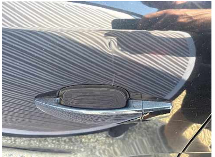
Türe hinten links (Kratzer, Delle)
