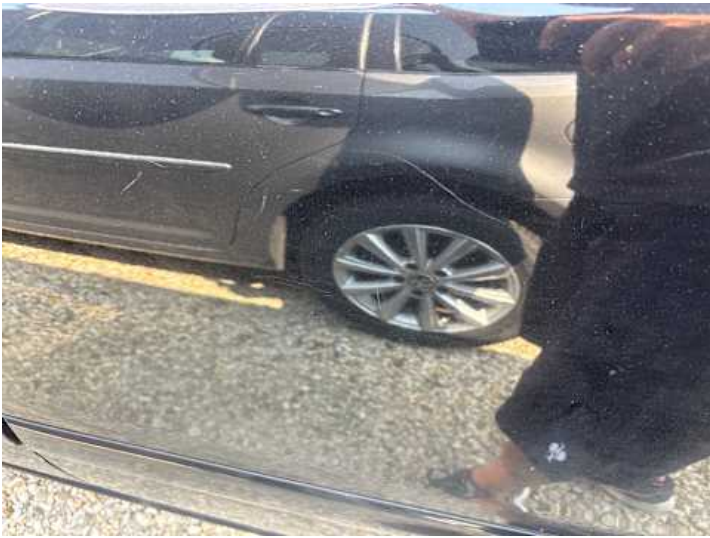
Türe hinten links (Kratzer, Unsachgemäß instand gesetzt)
