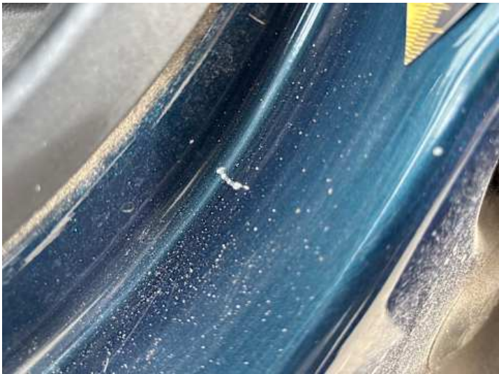
Schweller links (Kratzer)
