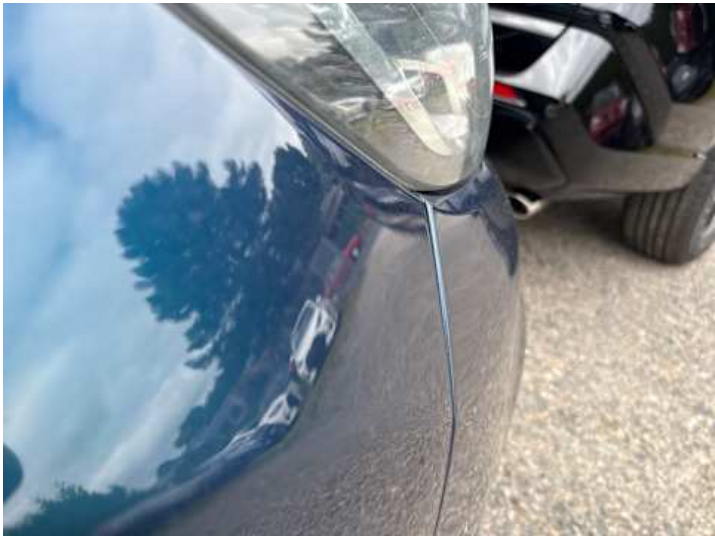
Kotflügel vorne rechts (Spaltmaße ungenau)
