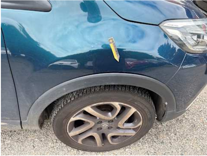
Kotflügel vorne rechts (Spaltmaße ungenau)
