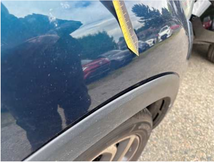
Kotflügel vorne rechts (Spaltmaße ungenau)
