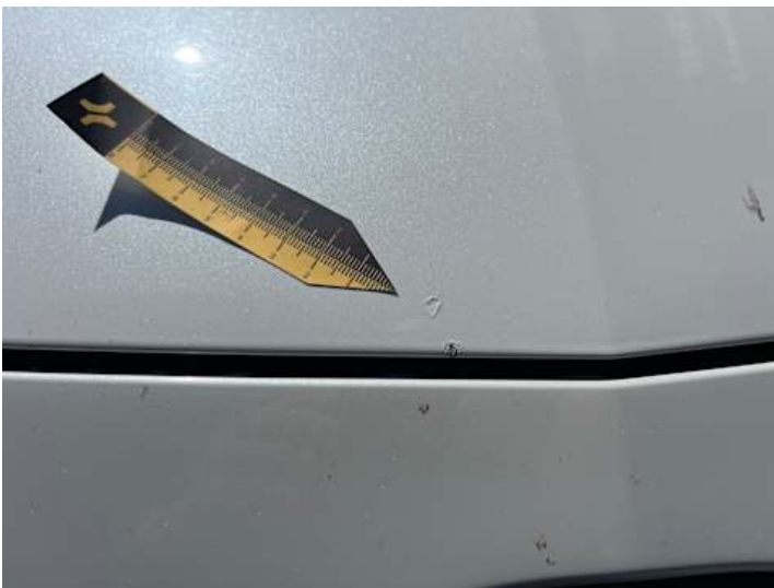
Motorhaube (Steinschlag, Unsachgemäß instand gesetzt)
