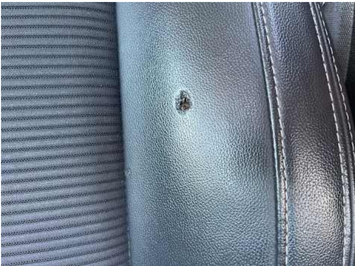
Innenraum (Riss/Bruch, Brandloch)
