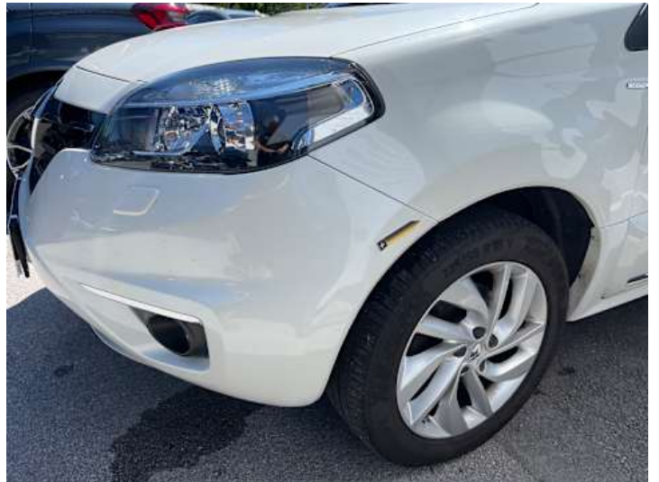
Stoßstange vorne (Lackschaden, Unsachgemäß instand gesetzt)
