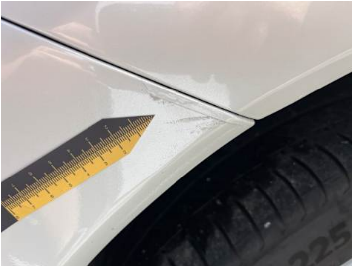
Stoßstange vorne (Lackschaden, Unsachgemäß instand gesetzt)
