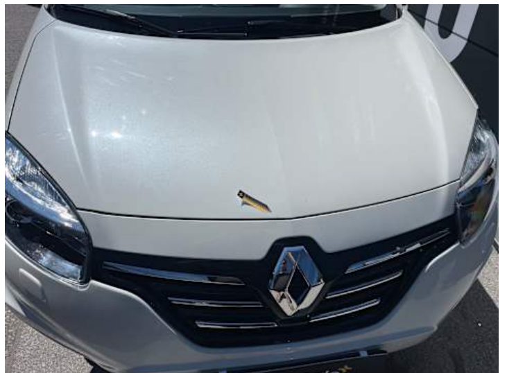
Motorhaube (Steinschlag, Unsachgemäß instand gesetzt)
