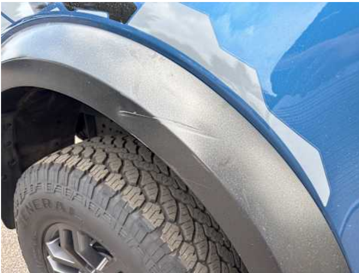
Seitenteil hinten rechts (Verformung, Lackschaden)
