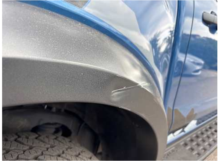
Seitenteil hinten rechts (Verformung, Lackschaden)
