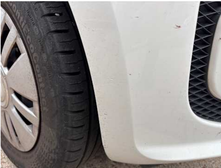
Stoßstange vorne (Lackschaden, Steinschlag)
