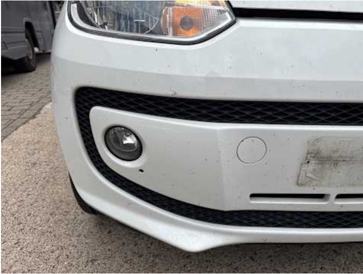
Stoßstange vorne (Lackschaden, Steinschlag)
