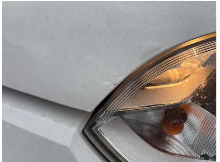
Motorhaube (Unsachgemäß instand gesetzt, Lackschaden)
