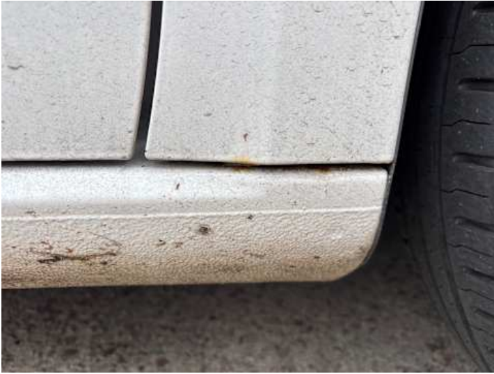
Schweller rechts (Rost)
