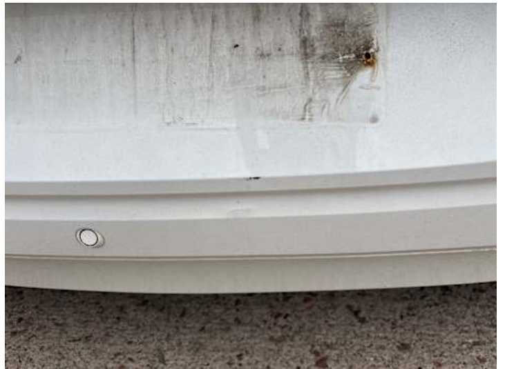
Stoßstange hinten (Lackschaden)
