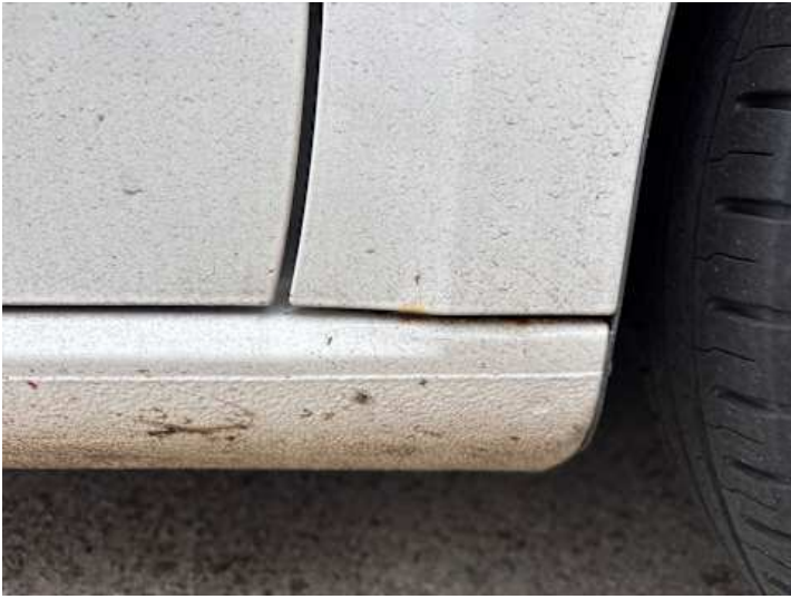
Kotflügel vorne rechts (Rost)
