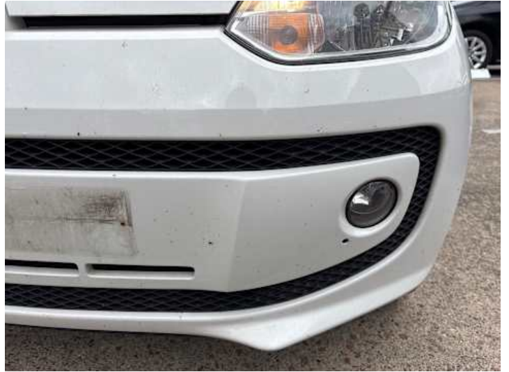
Stoßstange vorne (Lackschaden, Steinschlag)
