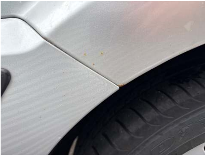
Seitenteil hinten rechts (Rost)
