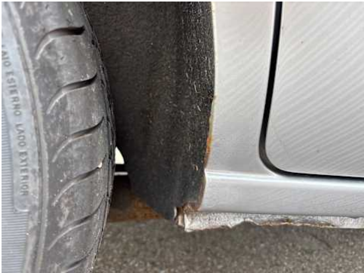
Seitenteil hinten rechts (Rost)
