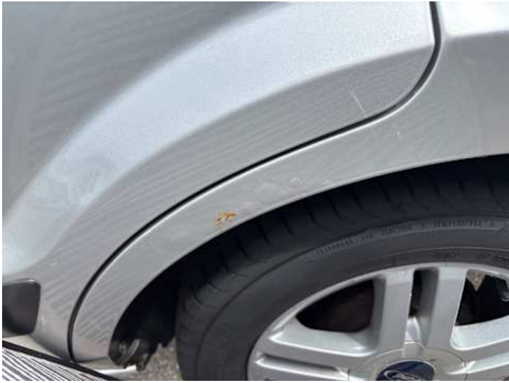
Seitenteil hinten links (Rost, Delle)
