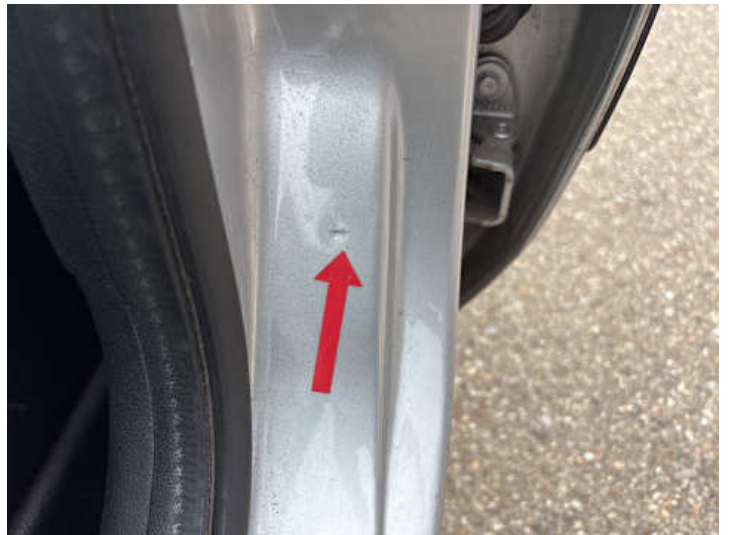
Fahrtür (Lackschaden, Kratzer)
