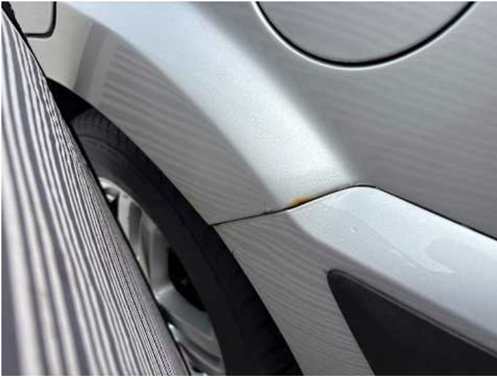
Seitenteil hinten links (Rost, Delle)
