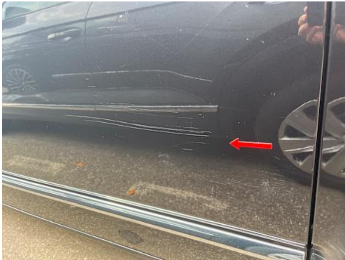
Türe hinten links (Lackschaden)
