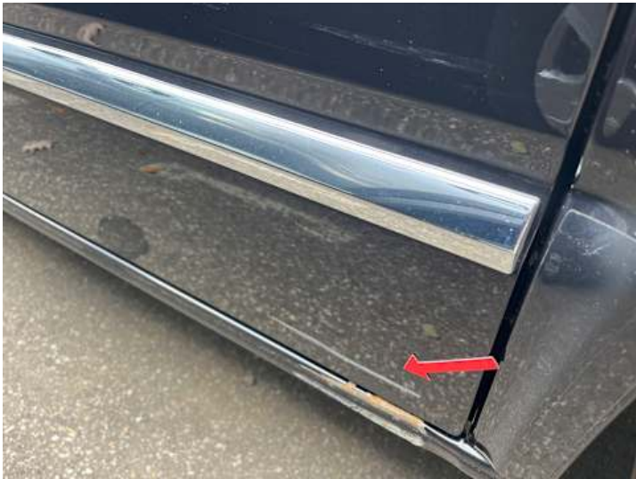
Türe hinten links (Lackschaden)
