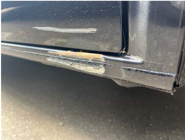
Schweller links (Verformung, Lackschaden)
