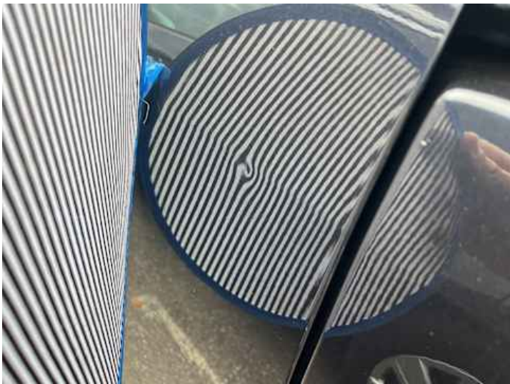
Türe hinten links (Delle)
