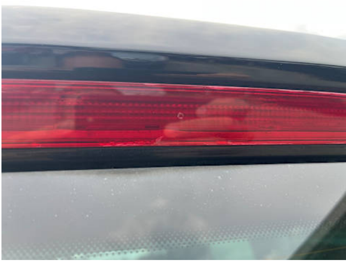
Heckklappe (Anderer Schaden): Bremsleuchte riss
