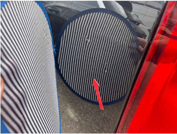
Seitenteil hinten links (Lackschaden, Delle)
