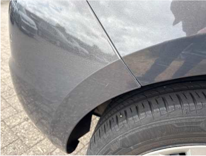
Stoßstange hinten (Kratzer, Spaltmaße ungenau)
