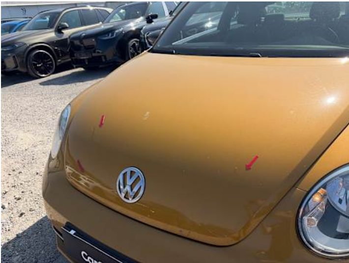
Motorhaube (Kratzer, Steinschlag, Lackschaden)
