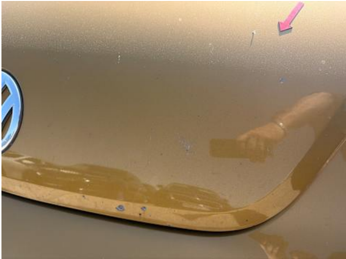
Motorhaube (Kratzer, Steinschlag, Lackschaden)
