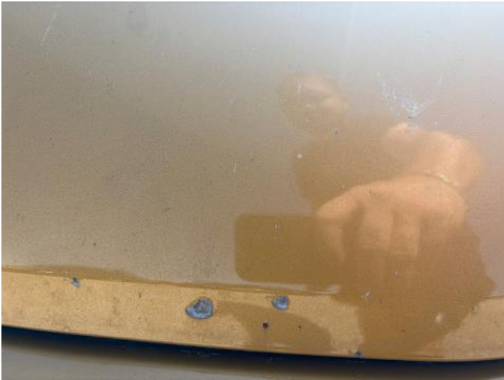
Motorhaube (Kratzer, Steinschlag, Lackschaden)
