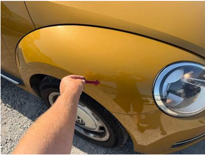
Kotflügel vorne rechts (Kratzer)
