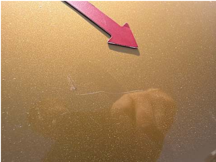
Motorhaube (Kratzer, Steinschlag, Lackschaden)
