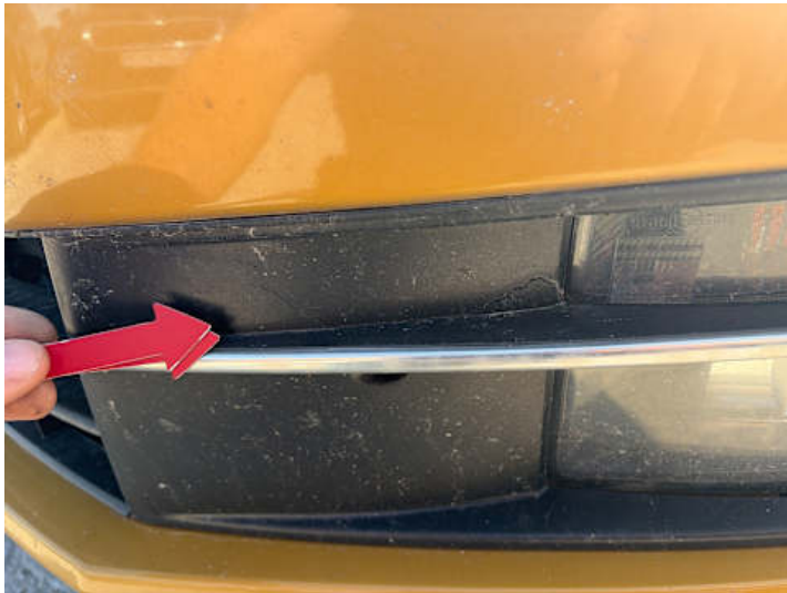
Stoßstange vorne (Riss/Bruch)
