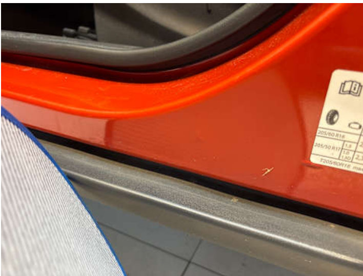
Schweller links (Kratzer, Delle)
