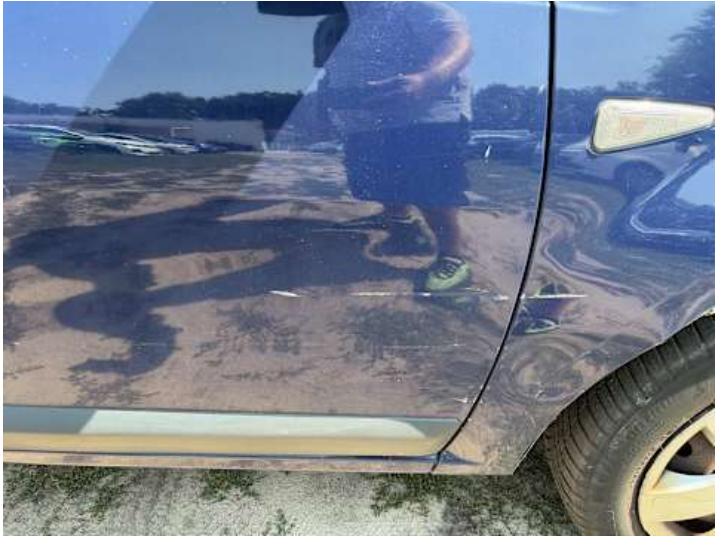
Beifahrtür (Kratzer, Delle, Verformung)
