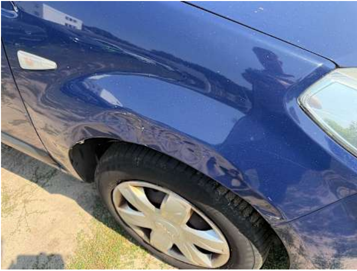
Kotflügel vorne rechts (Verformung, Kratzer)
