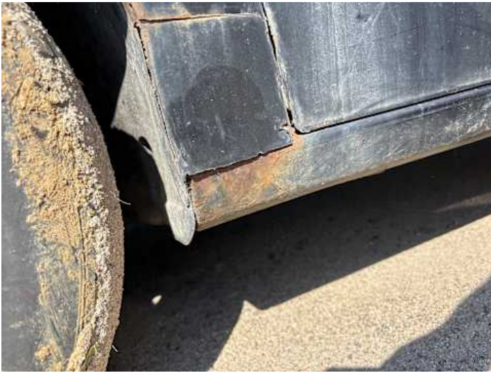
Schweller links (Rost)
