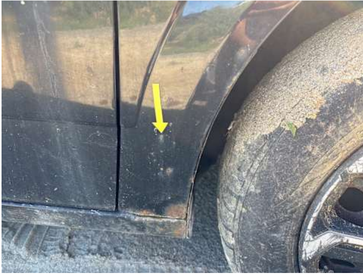
Kotflügel vorne rechts (Rost)
