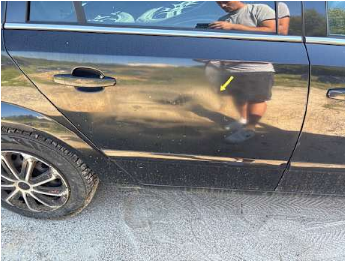
Türe hinten rechts (Ausgeblichen/Matt, Unsachgemäß instand gesetzt)
