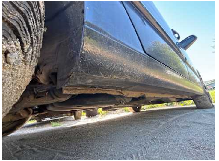
Schweller rechts (Rost)
