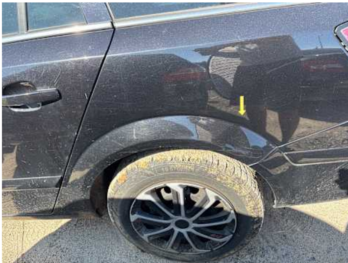
Seitenteil hinten links (Verformung, Kratzer)
