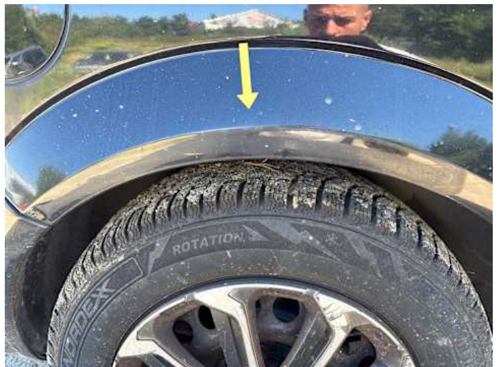
Seitenteil hinten rechts (Kratzer, Lackschaden, Rost)
