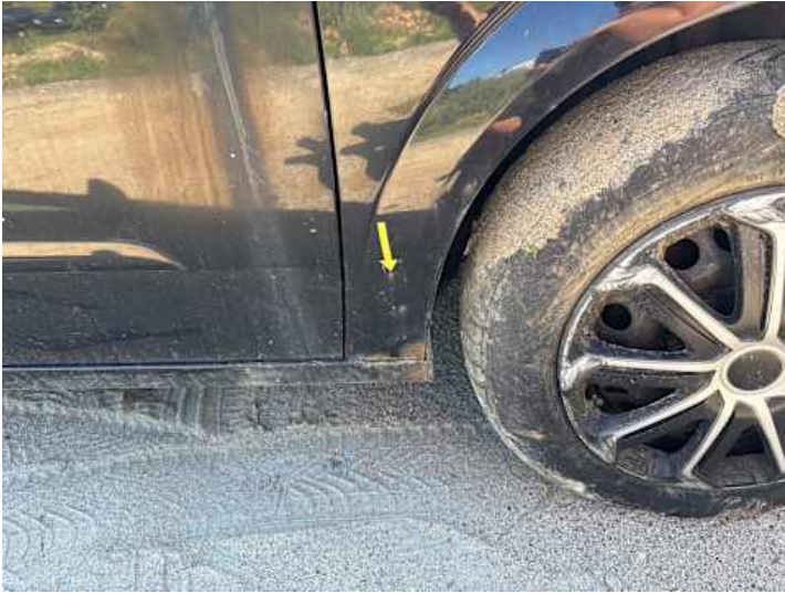
Kotflügel vorne rechts (Rost)
