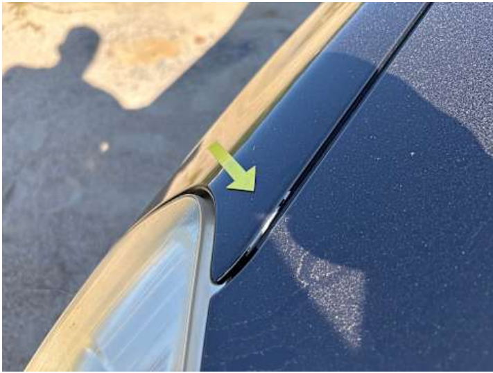
Kotflügel vorne rechts (Lackschaden)
