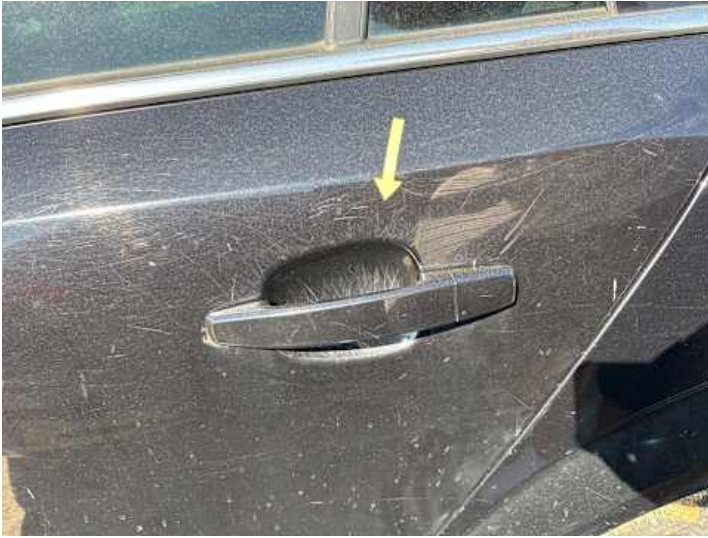
Türe hinten links (Rost, Kratzer, Unsachgemäß instand gesetzt)
