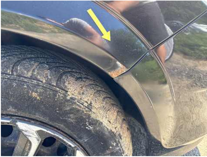
Kotflügel vorne rechts (Rost)
