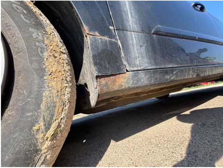
Schweller links (Rost)
