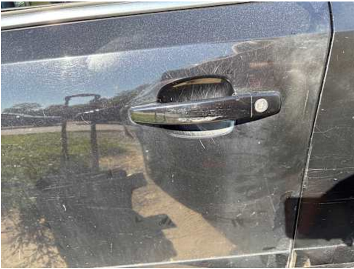
Fahrtür (Lackschaden, Verformung, Unsachgemäß instand gesetzt)
