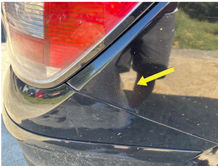
Seitenteil hinten rechts (Kratzer, Lackschaden, Rost)
