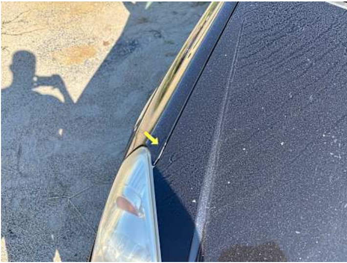
Kotflügel vorne rechts (Lackschaden)
