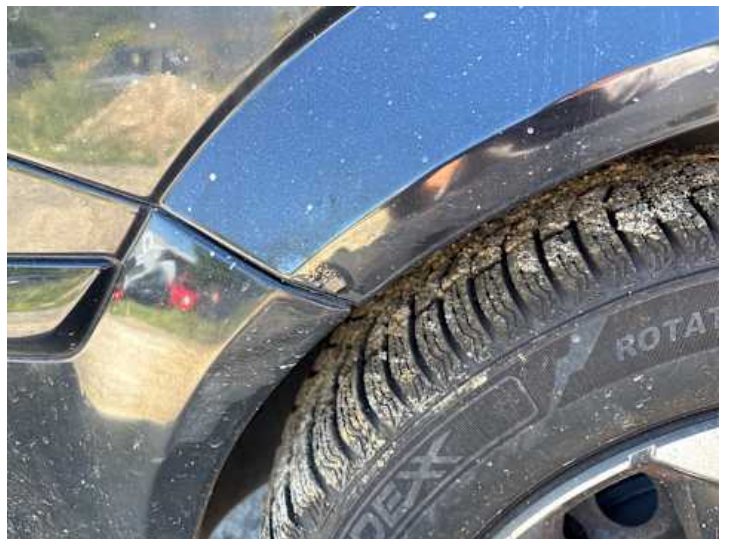
Seitenteil hinten rechts (Kratzer, Lackschaden, Rost)
