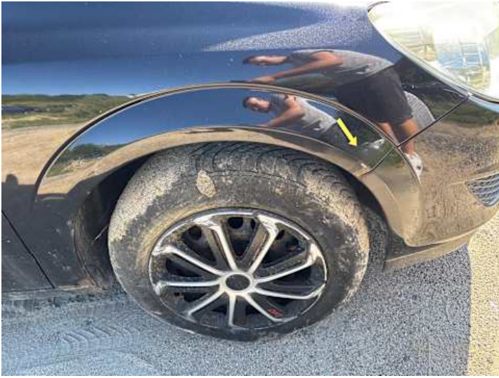
Kotflügel vorne rechts (Rost)
