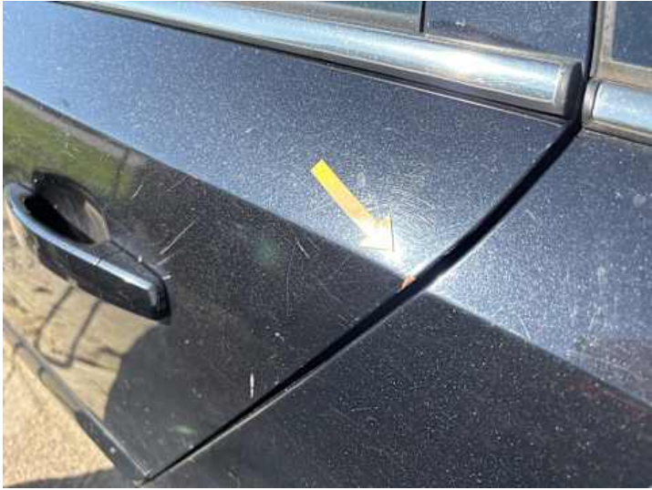
Türe hinten links (Rost, Kratzer, Unsachgemäß instand gesetzt)
