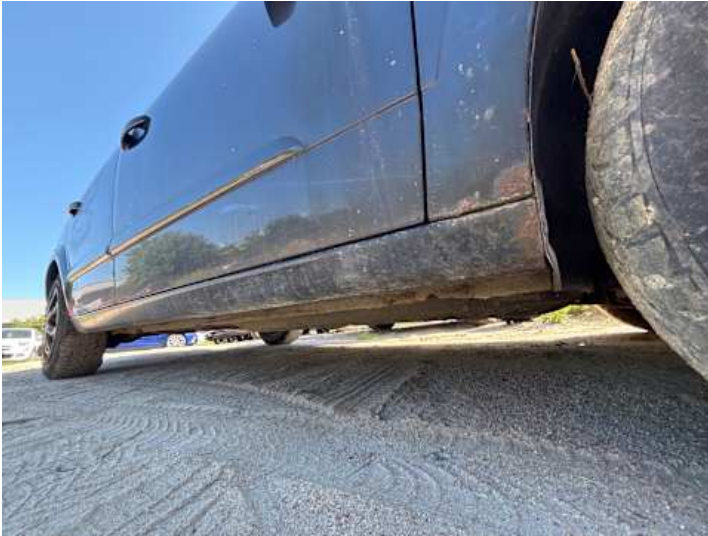
Schweller rechts (Rost)
