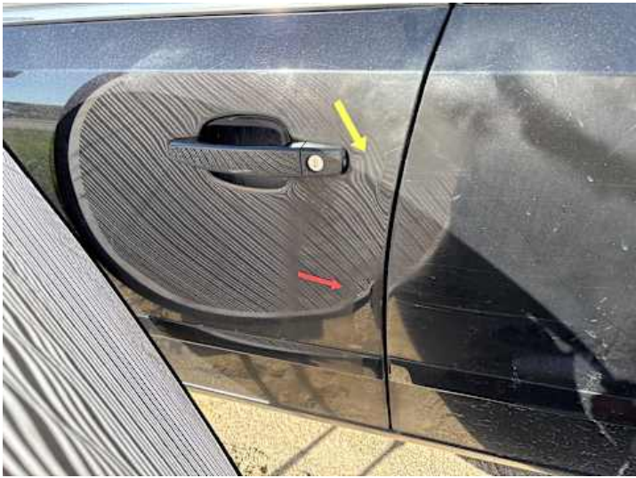
Fahrtür (Lackschaden, Verformung, Unsachgemäß instand gesetzt)
