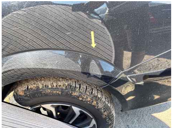
Seitenteil hinten links (Verformung, Kratzer)
