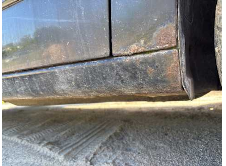
Schweller rechts (Rost)
