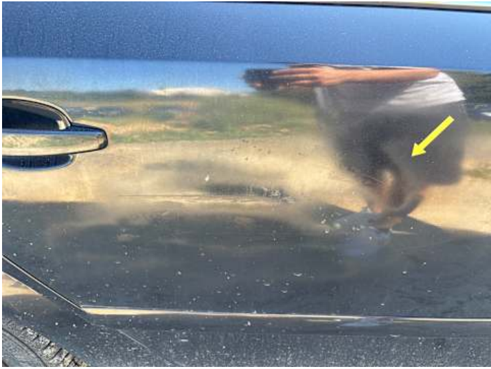
Türe hinten rechts (Ausgeblichen/Matt, Unsachgemäß instand gesetzt)
