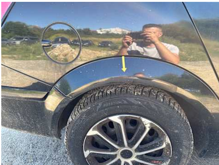
Seitenteil hinten rechts (Kratzer, Lackschaden, Rost)
