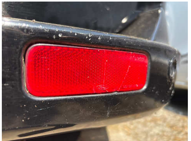
Rücklicht (rechts) (Riss/Bruch)
