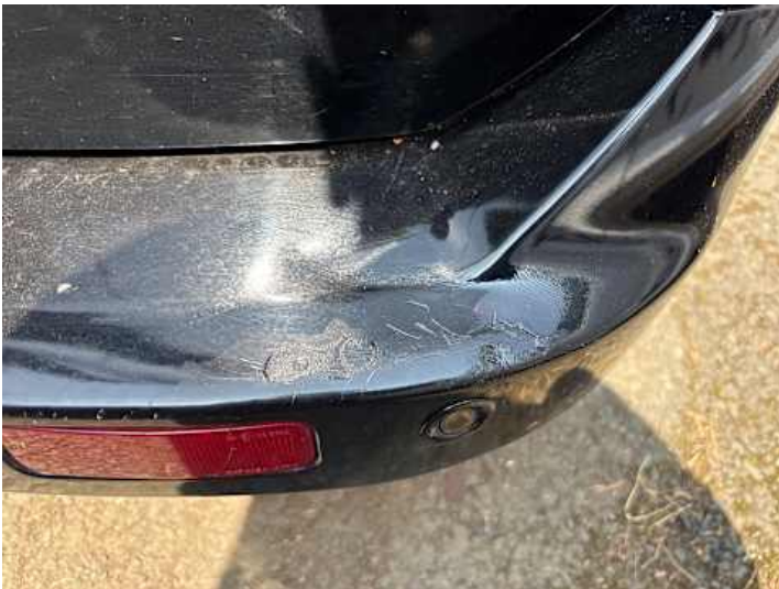
Stoßstange hinten (Kratzer, Unsachgemäß instand gesetzt)
