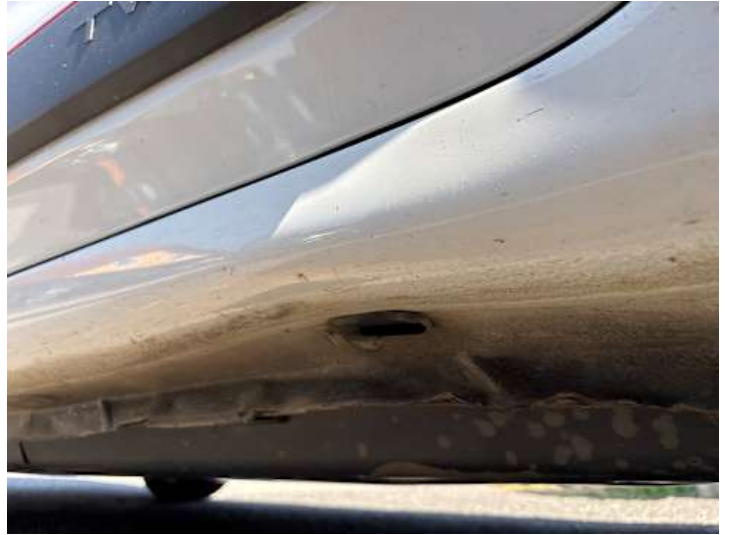
Schweller links (Verformung)
