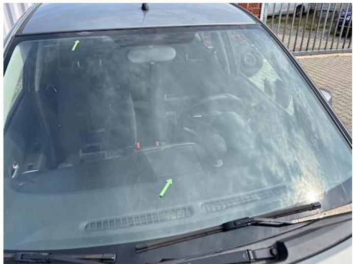
Windschutzscheibe (Steinschlag, Anderer Schaden): Undicht
