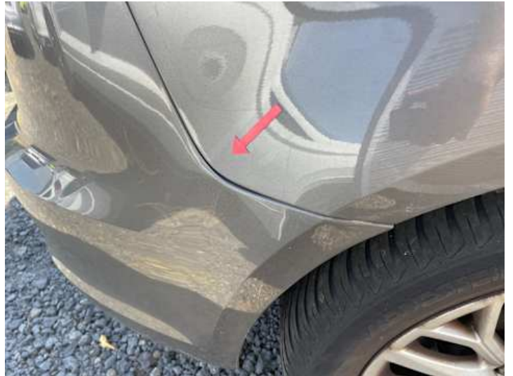
Stoßstange hinten (Spaltmaße ungenau)
