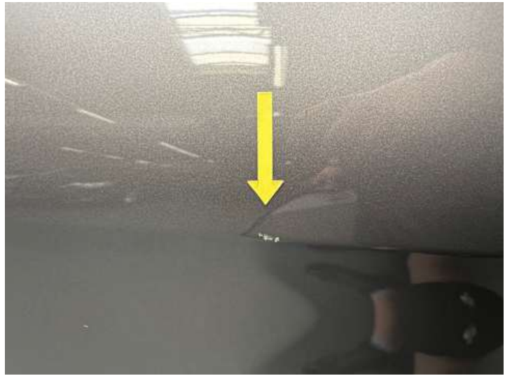
Türe hinten links (Kratzer)
