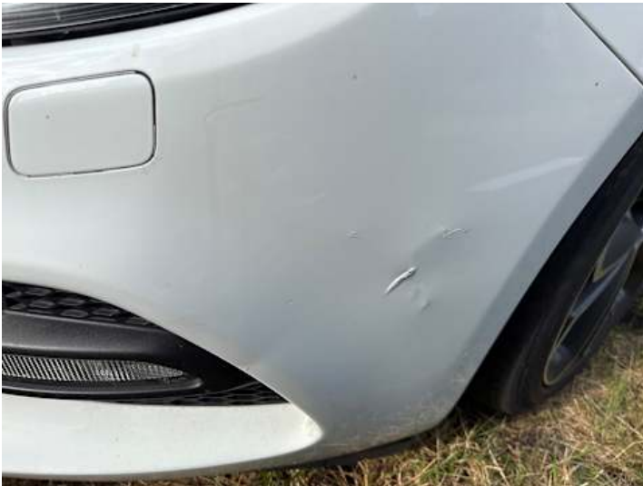
Stoßstange vorne (Kratzer, Riss/Bruch)
