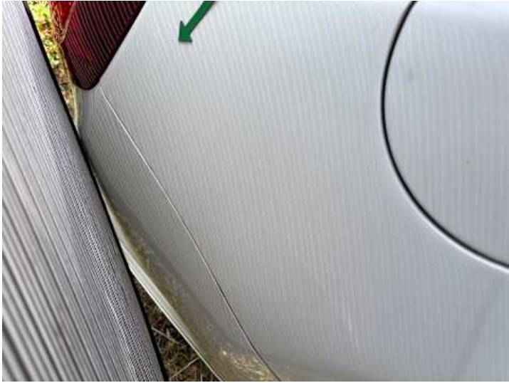
Seitenteil hinten rechts (Unsachgemäß instand gesetzt)
