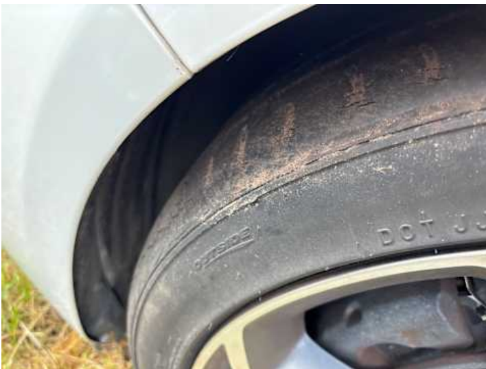
Rad (Ungleichmäßig abgefahren)
