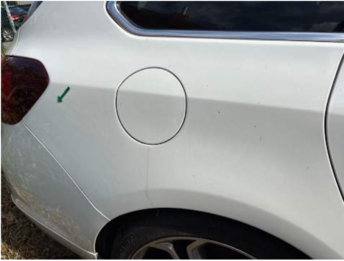
Seitenteil hinten rechts (Unsachgemäß instand gesetzt)
