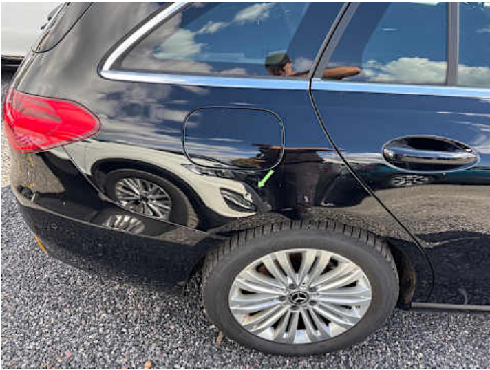
Seitenteil hinten rechts (Kratzer, Lackschaden, Delle)
