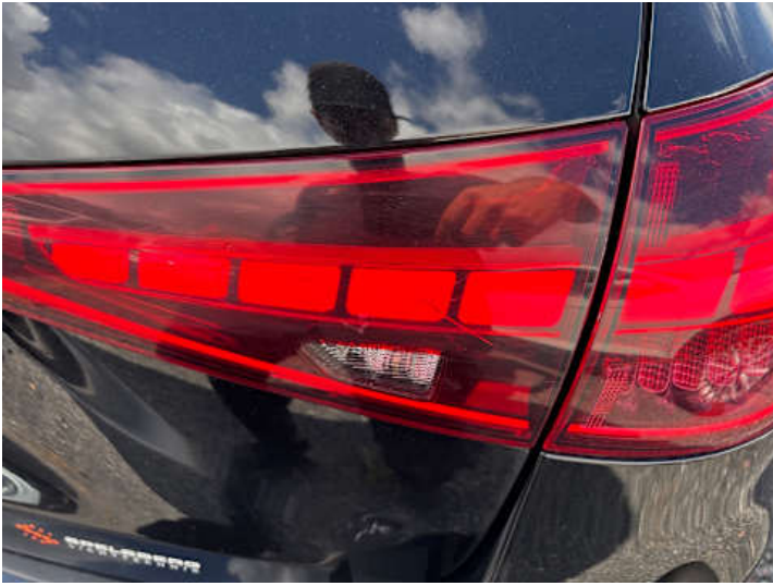
Rücklicht (rechts) (Riss/Bruch)
