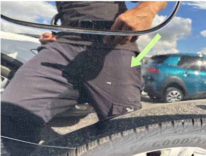
Seitenteil hinten rechts (Kratzer, Lackschaden, Delle)
