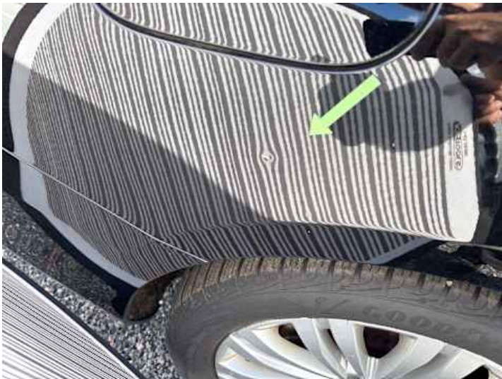
Seitenteil hinten rechts (Kratzer, Lackschaden, Delle)
