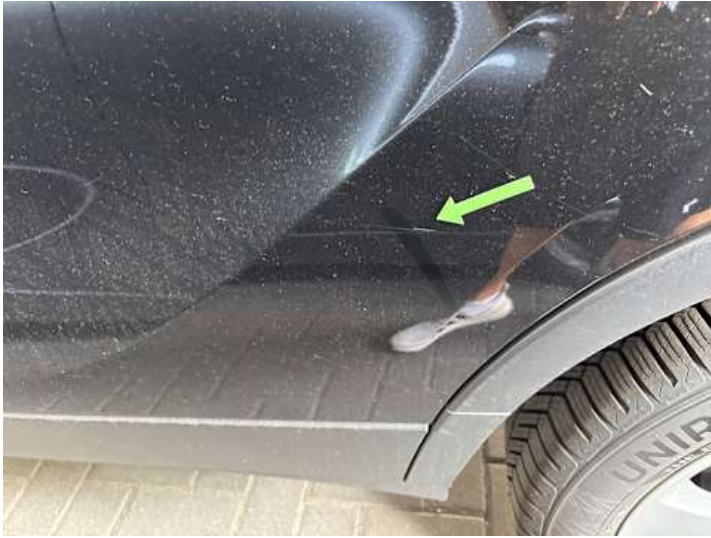
Türe hinten links (Kratzer, Lackschaden)
