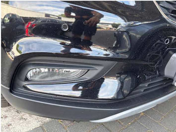
Stoßstange vorne (Steinschlag)
