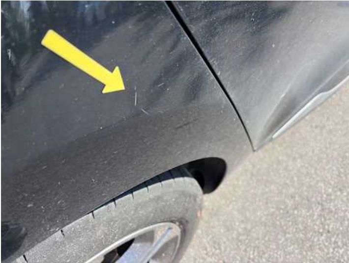
Seitenteil hinten rechts (Kratzer)
