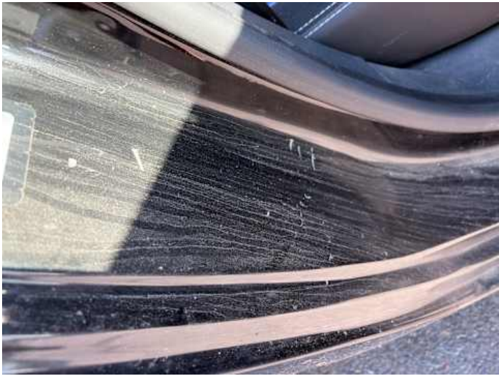
Schweller rechts (Lackschaden)
