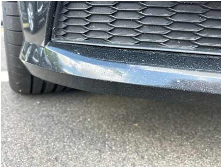
Stoßstange vorne (Lackschaden, Delle)
