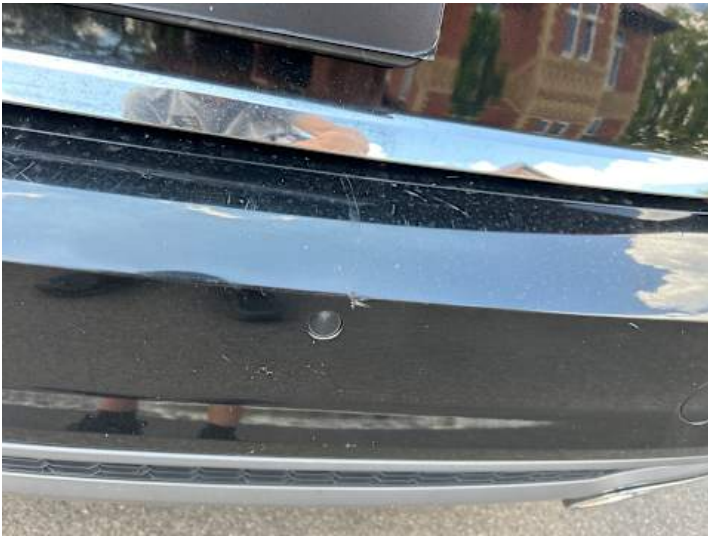
Stoßstange hinten (Riss/Bruch, Kratzer)
