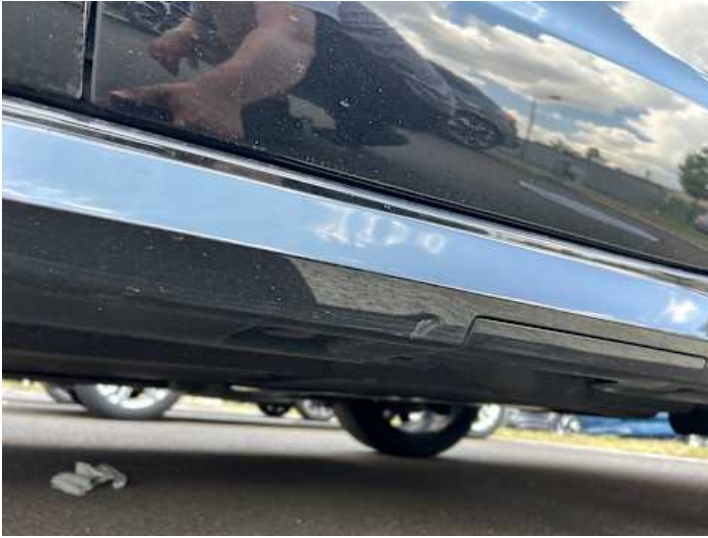
Schweller links (Kratzer, Delle)
