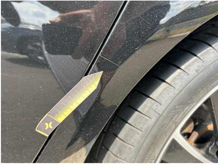
Seitenteil hinten links (Kratzer)
