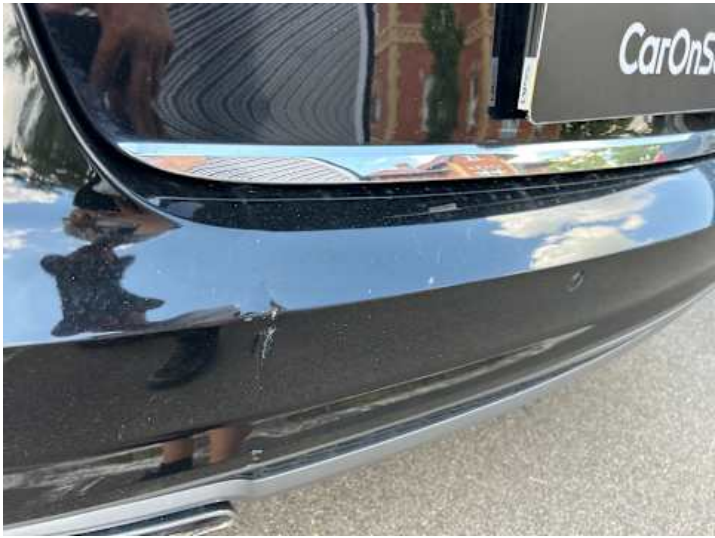
Stoßstange hinten (Riss/Bruch, Kratzer)
