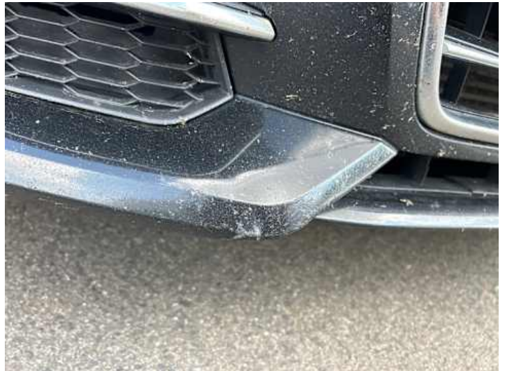
Stoßstange vorne (Lackschaden, Delle)
