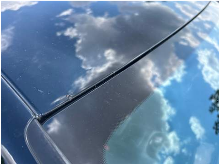
Dach (Rost, Steinschlag)
