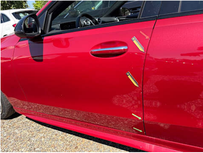
Fahrtür (Kratzer, Delle)
