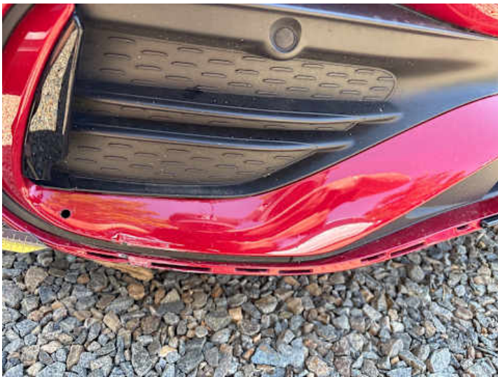
Stoßstange vorne (Riss/Bruch, Kratzer)
