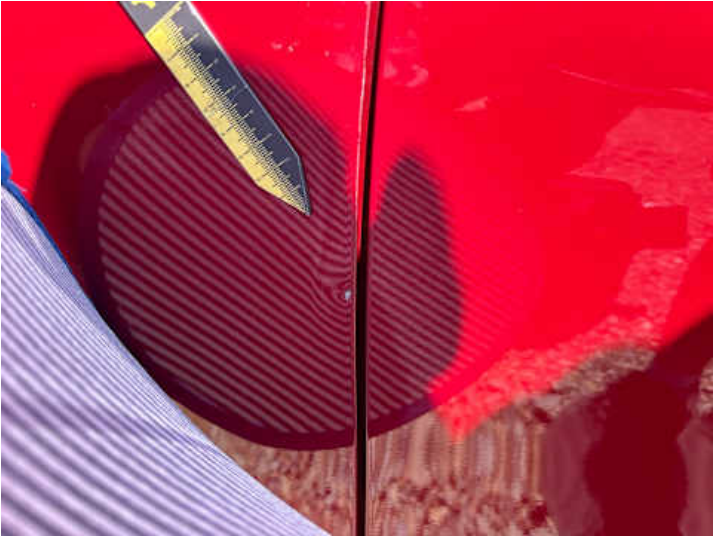
Fahrtür (Kratzer, Delle)
