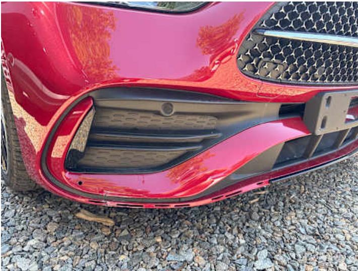
Stoßstange vorne (Riss/Bruch, Kratzer)
