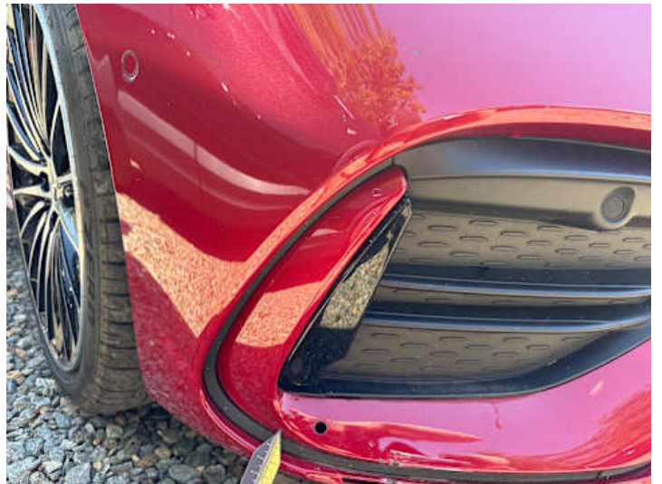
Stoßstange vorne (Riss/Bruch, Kratzer)
