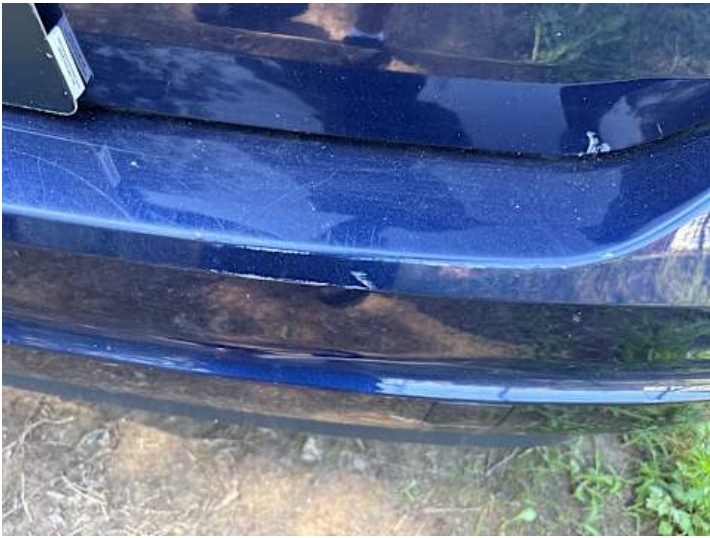
Stoßstange hinten (Kratzer, Lackschaden)
