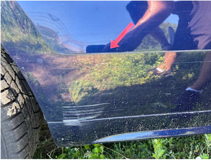
Türe hinten rechts (Kratzer)
