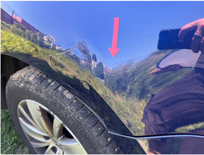
Kotflügel vorne rechts (Verformung, Lackschaden)
