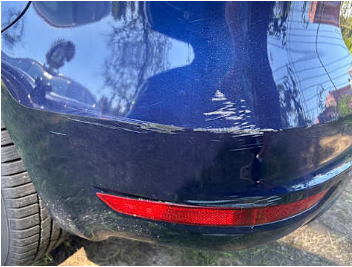
Stoßstange hinten (Kratzer, Lackschaden)
