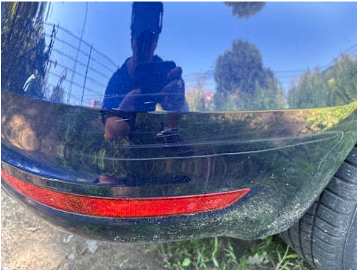
Stoßstange hinten (Kratzer, Lackschaden)
