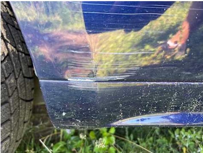
Schweller rechts (Kratzer)
