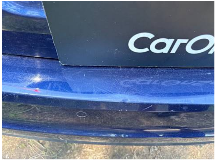
Stoßstange hinten (Kratzer, Lackschaden)
