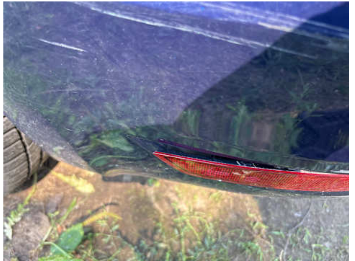
Stoßstange hinten (Riss/Bruch)
