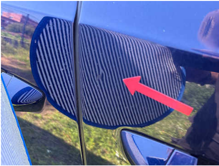
Beifahrertür (Delle, Kratzer)
