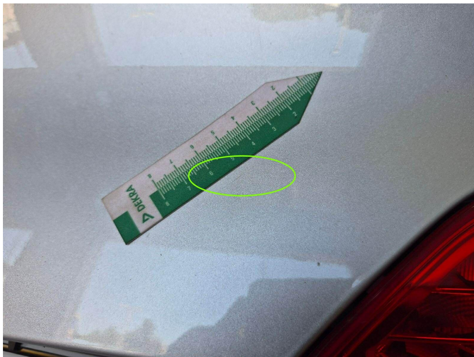
Bild 14 : Heckklappe rechtsseitig oberflächlich zerkratzt
