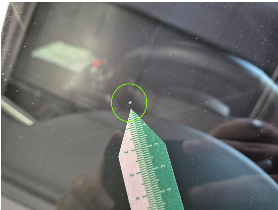
Bild 10 : Frontscheibe Steinschlag im Fahrersichtfeld
