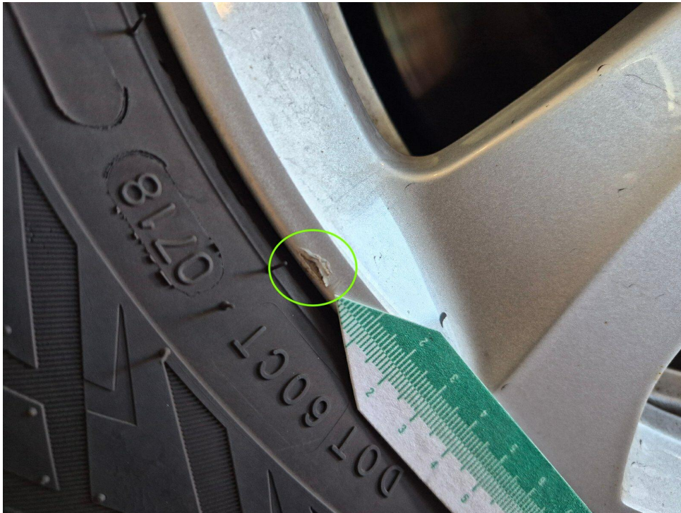
Bild 9 : Scheibenrad vorn links leicht verschrammt, Wertminderung
