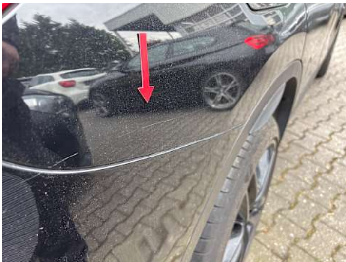
Seitenteil hinten rechts (Kratzer)
