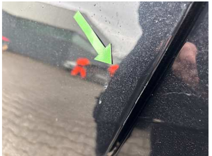
Türe hinten links (Lackschaden)
