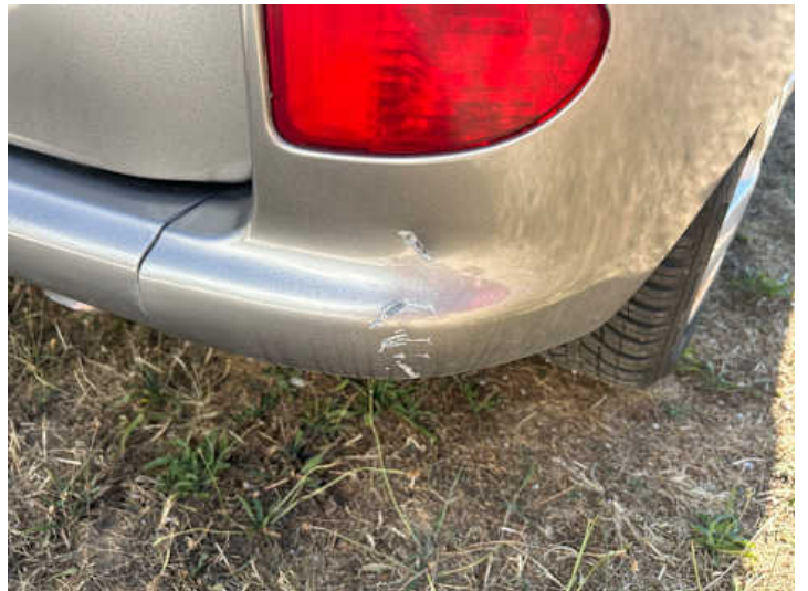
Stoßstange hinten (Kratzer, Verformung)
