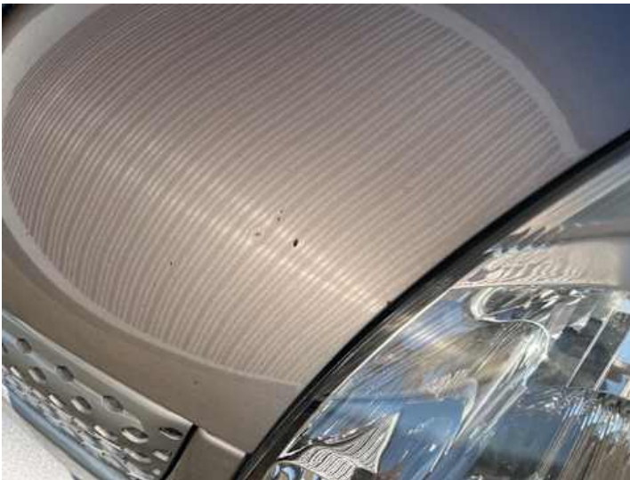
Motorhaube (Delle, Kratzer)
