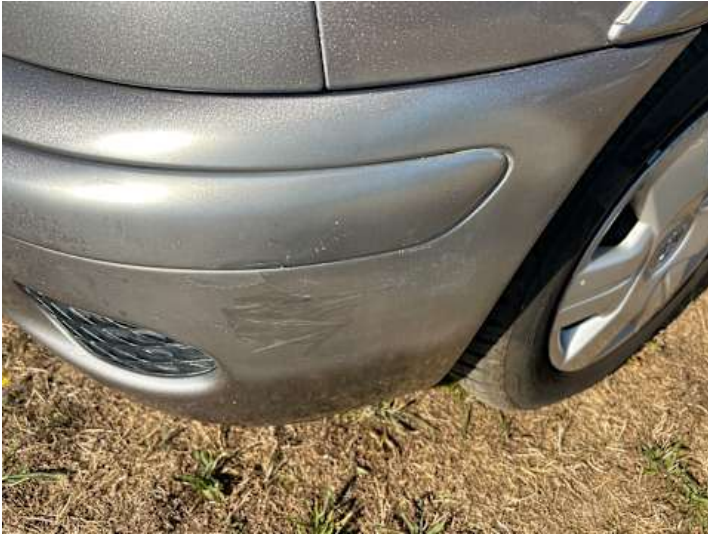
Stoßstange vorne (Kratzer, Lackschaden)
