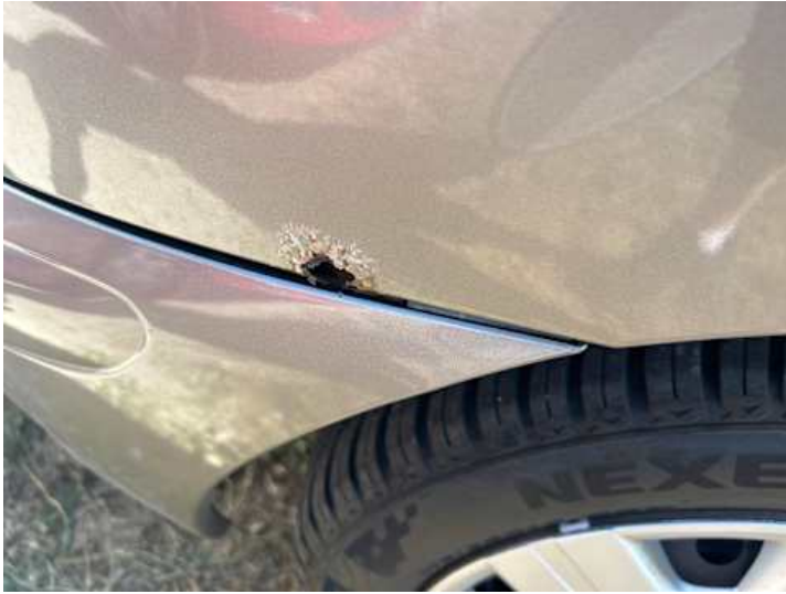
Seitenteil hinten rechts (Rost, Riss/Bruch)
