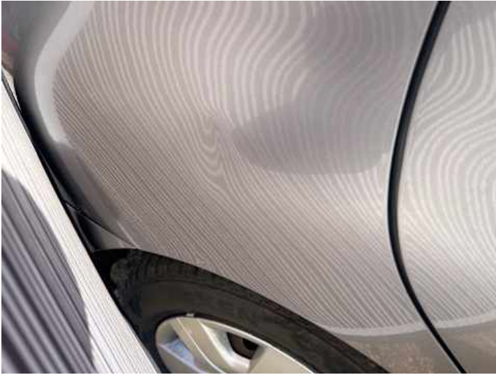
Seitenteil hinten rechts (Verformung)
