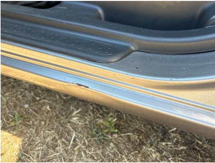
Schweller links (Lackschaden, Verformung)
