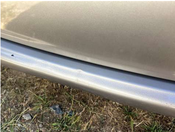
Stoßstange hinten (Kratzer, Verformung)
