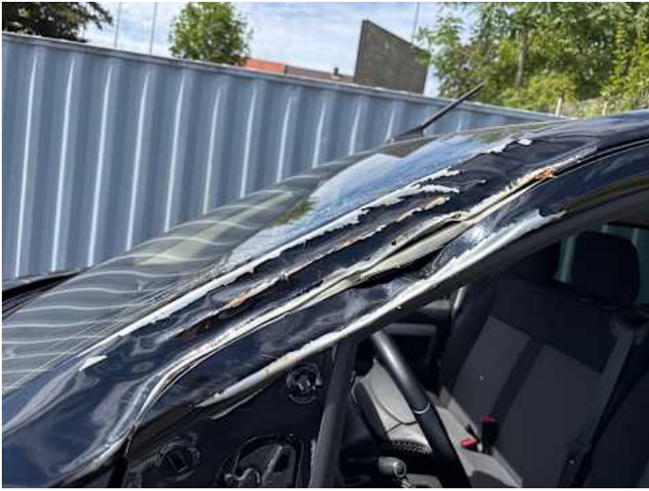
Dach (Lackschaden, Verformung, Riss/Bruch)
