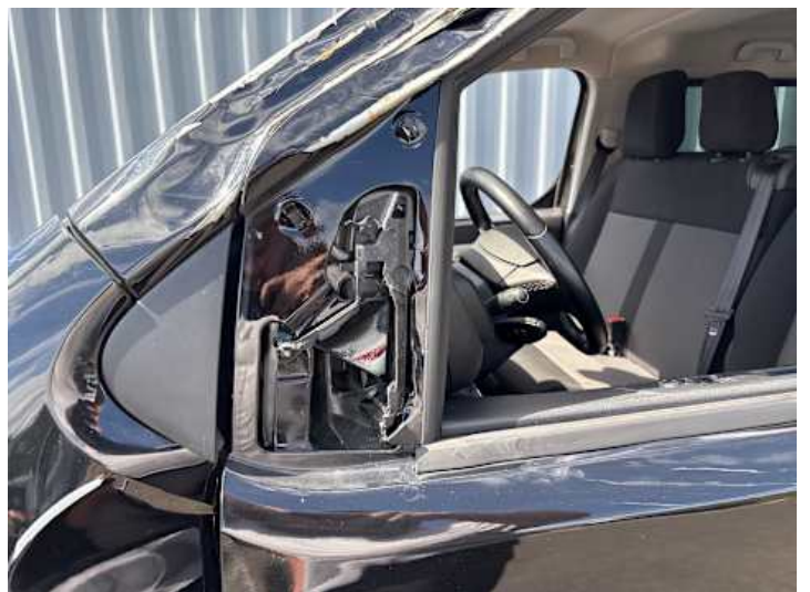
Fahrtür (Verformung, Riss/Bruch, Lackschaden)
