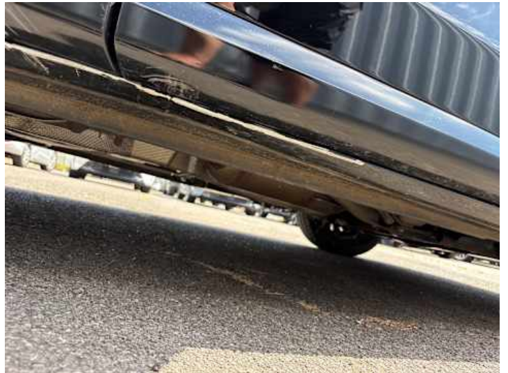
Schweller rechts (Lackschaden, Verformung)
