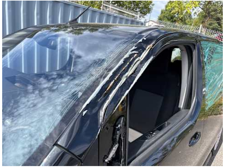
Dach (Lackschaden, Verformung, Riss/Bruch)
