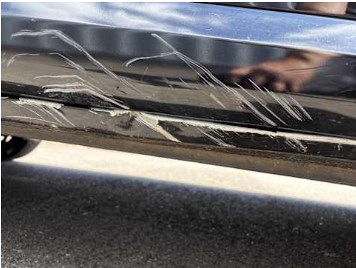
Schweller rechts (Lackschaden, Verformung)
