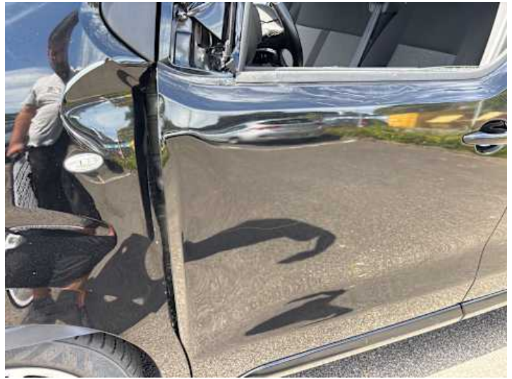
Fahrtür (Verformung, Riss/Bruch, Lackschaden)
