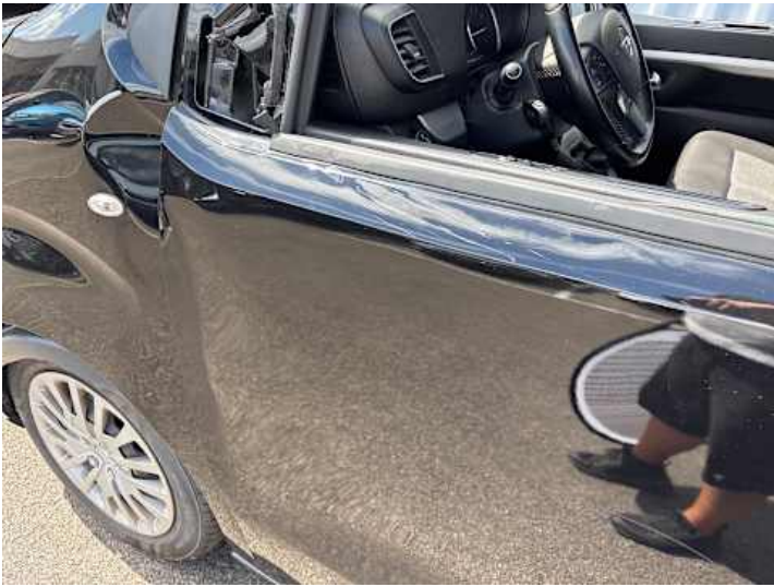
Fahrtür (Verformung, Riss/Bruch, Lackschaden)
