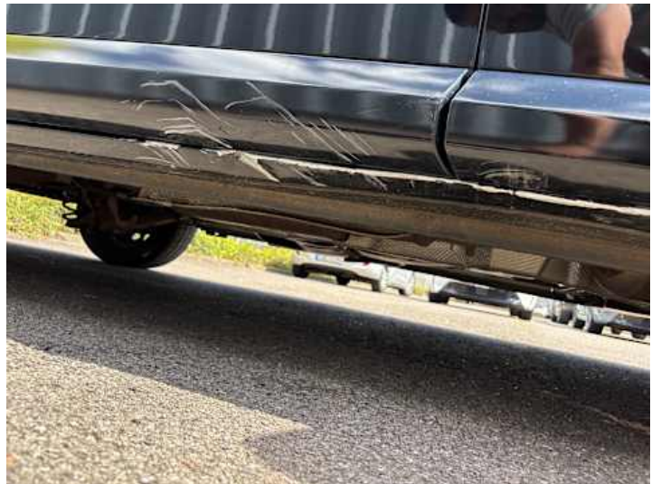
Schweller rechts (Lackschaden, Verformung)
