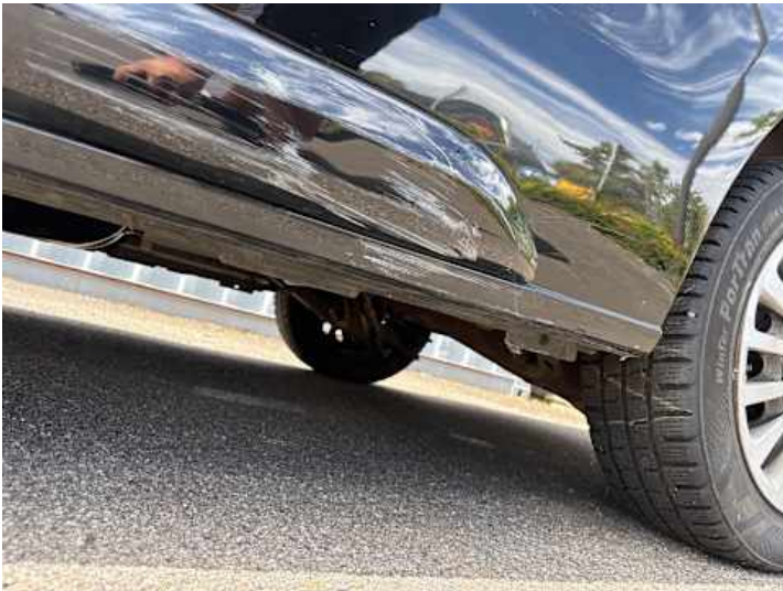
Schweller links (Lackschaden, Verformung)
