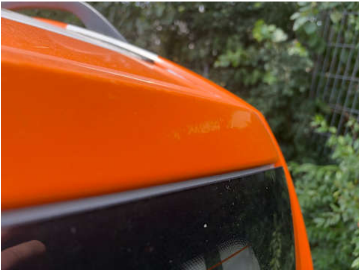
Heckklappe (Lackschaden, Delle)
