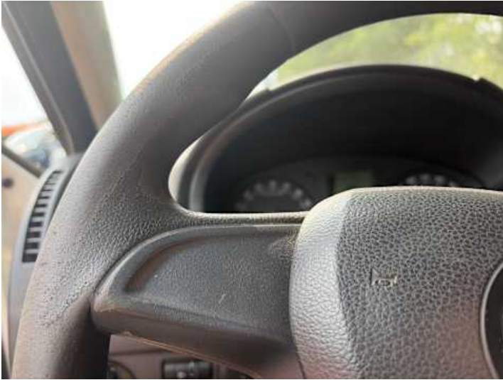
Innenraum (Brandloch, Verschleiß)
