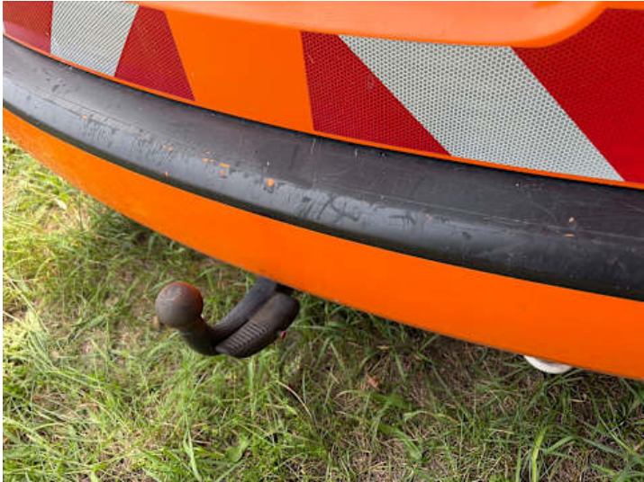
Stoßstange hinten (Riss/Bruch, Kratzer)
