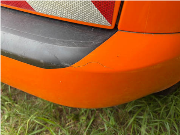
Stoßstange hinten (Riss/Bruch, Kratzer)
