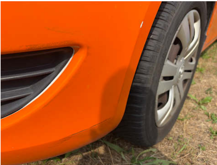
Stoßstange vorne (Lackschaden)
