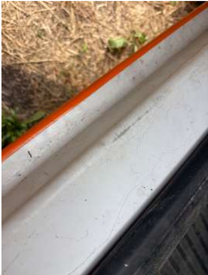
Schweller links (Lackschaden)
