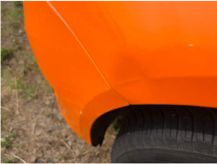
Kotflügel vorne links (Delle, Lackschaden)
