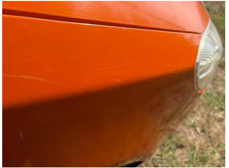
Kotflügel vorne rechts (Lackschaden)
