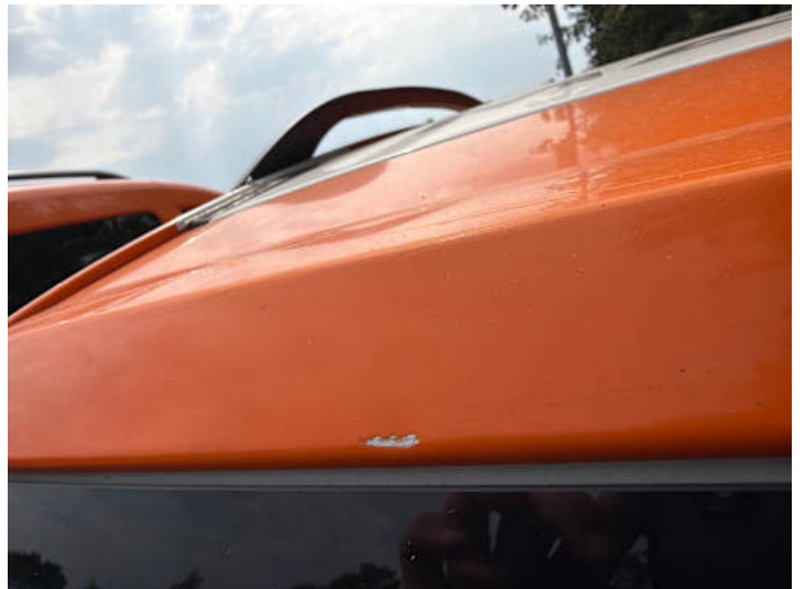
Heckklappe (Lackschaden, Delle)
