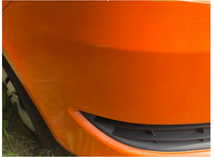
Stoßstange vorne (Lackschaden)
