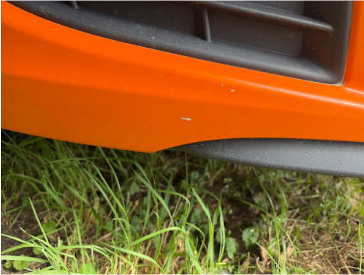
Stoßstange vorne (Lackschaden)
