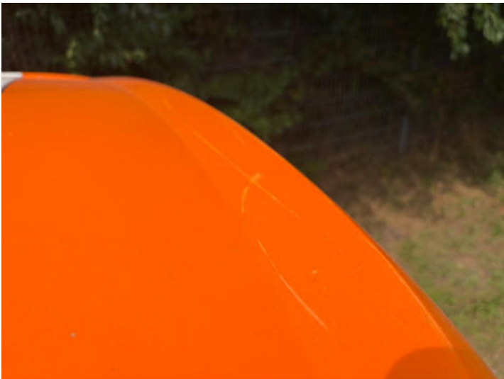
Heckklappe (Lackschaden, Delle)
