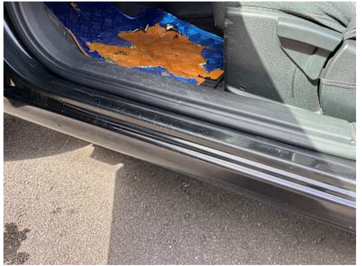
Schweller links (Kratzer, Rost)
