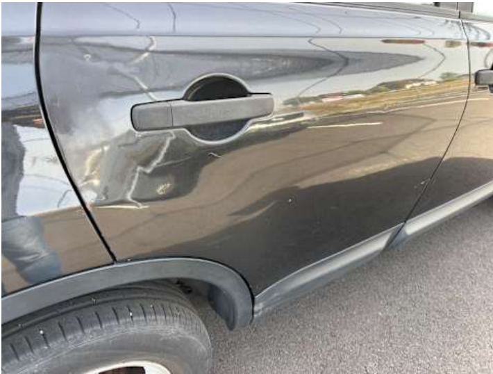
Türe hinten rechts (Kratzer, Rost, Delle)
