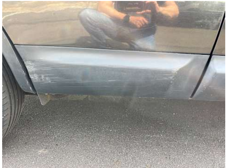
Türe hinten rechts (Kratzer, Rost, Delle)
