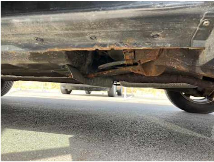
Schweller links (Kratzer, Rost)
