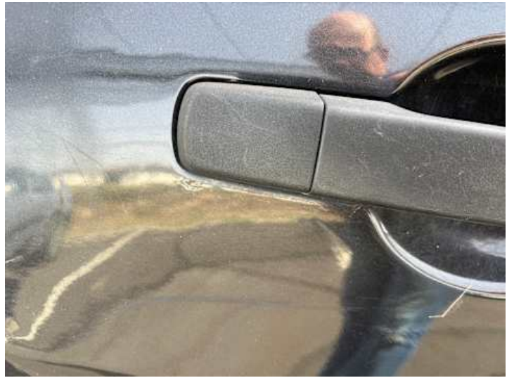
Türe hinten rechts (Kratzer, Rost, Delle)
