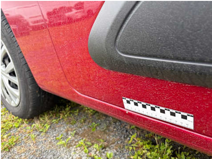
Schweller rechts (Lackschaden)
