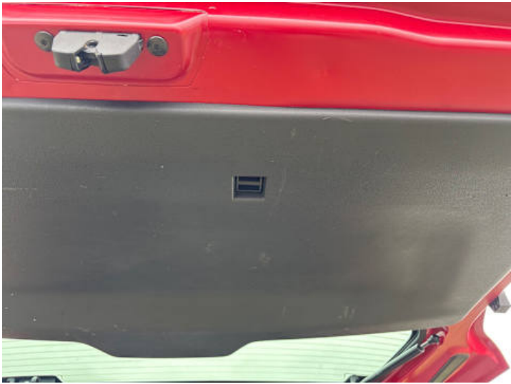
Innenraum (Anderer Schaden): Zugband fehlt
