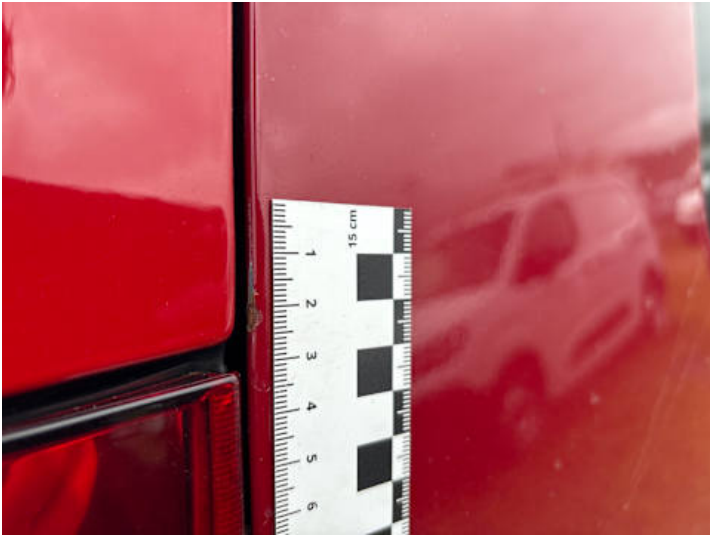
Seitenteil hinten rechts (Rost)
