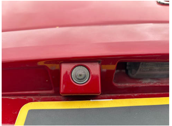
Heckklappe (Anderer Schaden): Rückfahrkamera angelaufen
