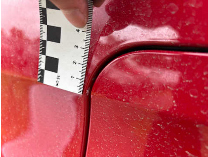
Seitenteil hinten links (Lackschaden)
