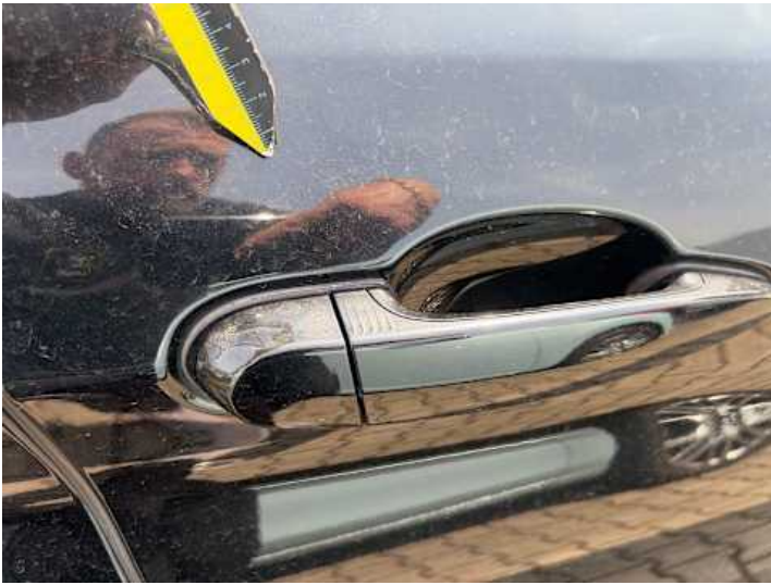
Beifahrertür (Lackschaden, Kratzer)
