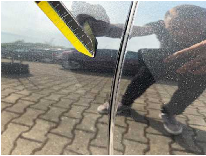
Fahrtür (Lackschaden, Kratzer)
