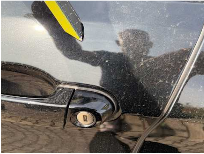
Fahrtür (Lackschaden, Kratzer)
