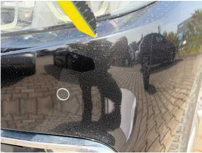
Stoßstange vorne (Lackschaden, Kratzer)
