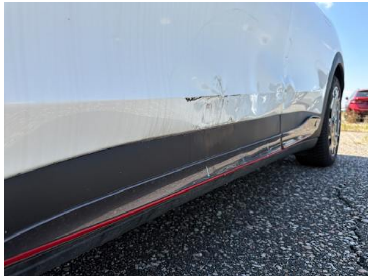
Fahrtür (Verformung, Kratzer, Lackschaden)
