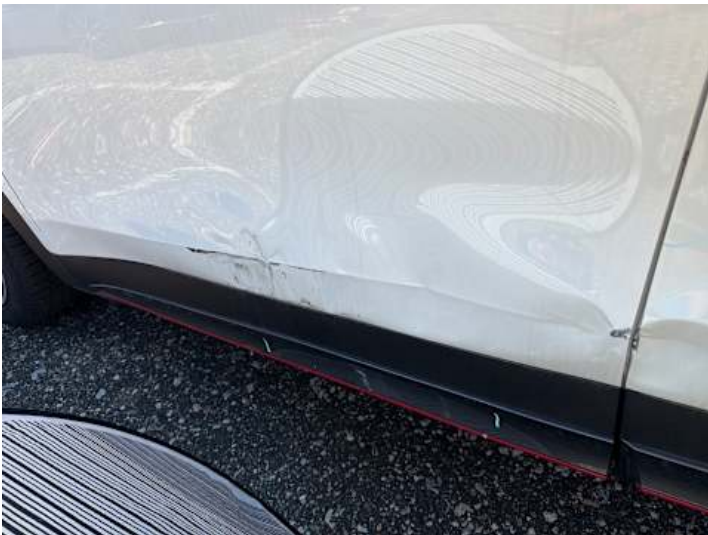
Fahrtür (Verformung, Kratzer, Lackschaden)
