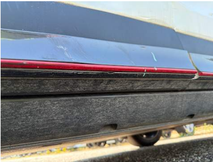
Fahrtür (Verformung, Kratzer, Lackschaden)
