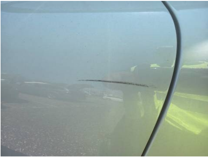
Türe hinten links (Verformung, Kratzer, Lackschaden)
