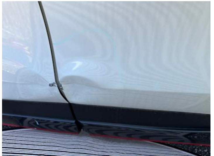
Türe hinten links (Verformung, Kratzer, Lackschaden)
