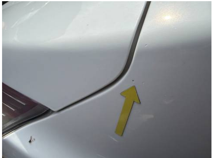
Kotflügel vorne links (Lackschaden)
