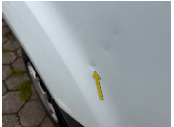
Seitenteil hinten links (Delle)
