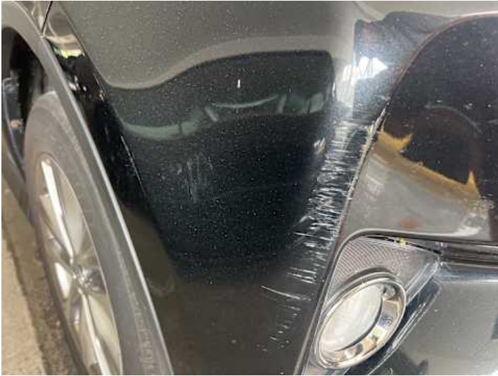
Stoßstange vorne (Lackschaden, Kratzer)
