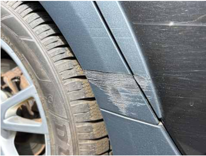
Seitenteil hinten rechts (Kratzer, Verformung)
