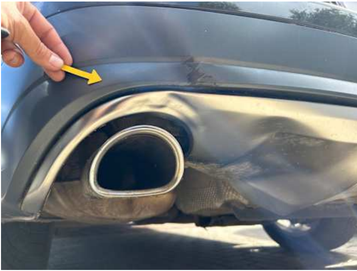
Stoßstange hinten (Kratzer, Verformung)
