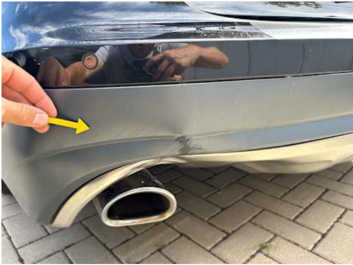
Stoßstange hinten (Kratzer, Verformung)
