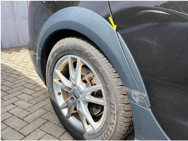
Seitenteil hinten rechts (Kratzer, Verformung)
