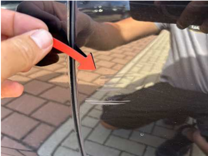
Türe hinten links (Kratzer)
