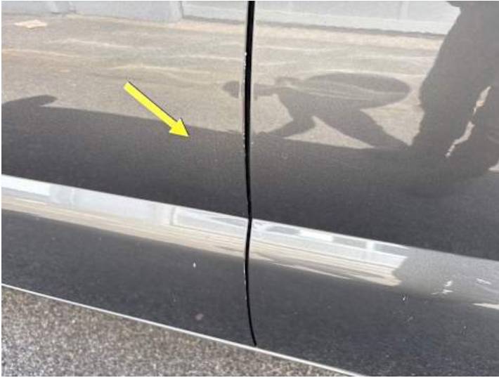
Fahrtür (Lackschaden, Rost)
