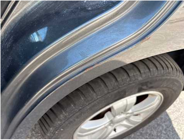
Seitenteil hinten links (Kratzer, Lackschaden, Delle, Rost)
