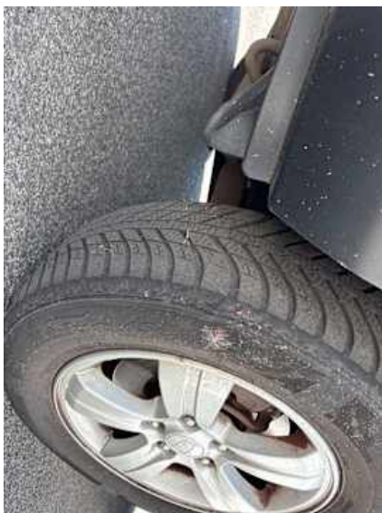
Rad (Ungleichmäßig abgefahren)
