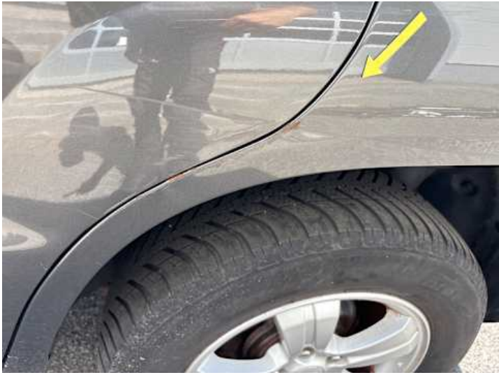
Seitenteil hinten links (Kratzer, Lackschaden, Delle, Rost)
