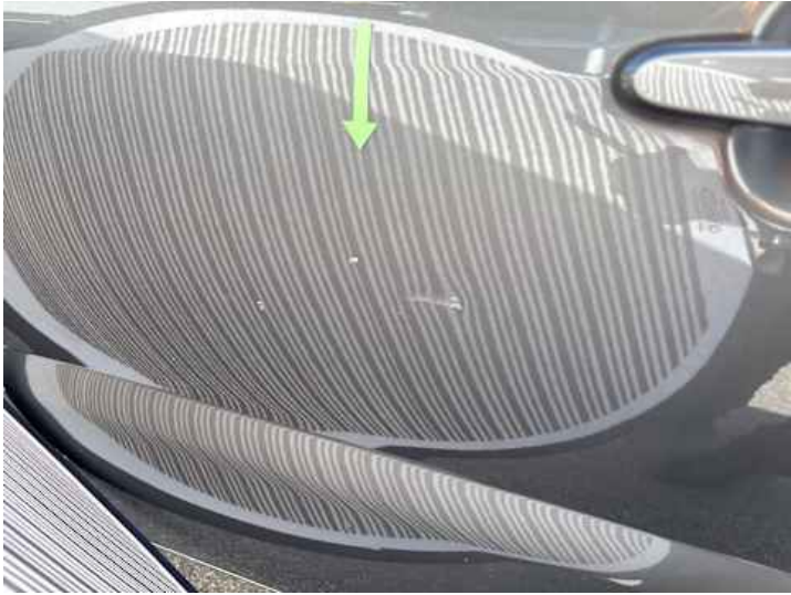
Fahrtür (Kratzer, Lackschaden, Delle)
