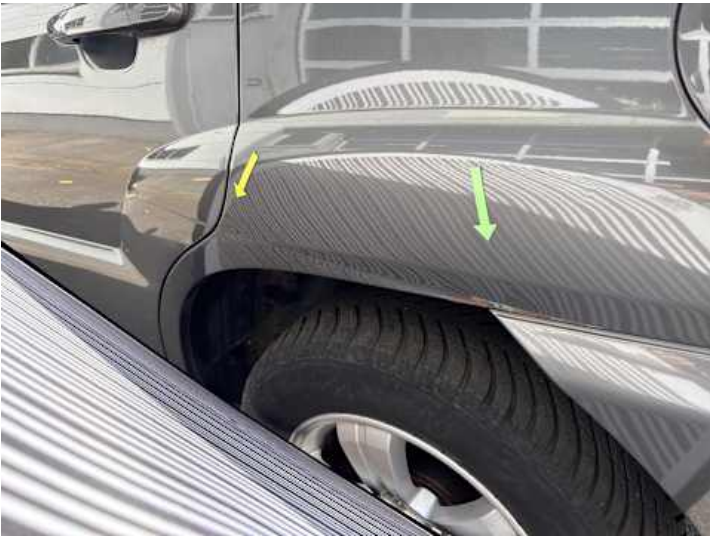
Seitenteil hinten links (Kratzer, Lackschaden, Delle, Rost)
