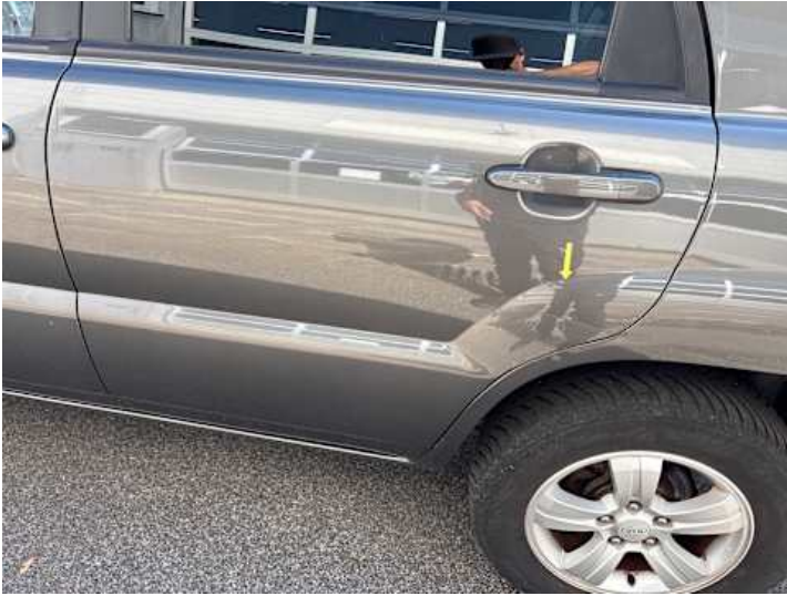
Türe hinten links (Kratzer, Lackschaden, Delle)
