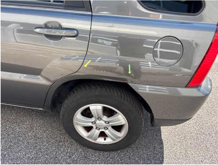
Seitenteil hinten links (Kratzer, Lackschaden, Delle, Rost)
