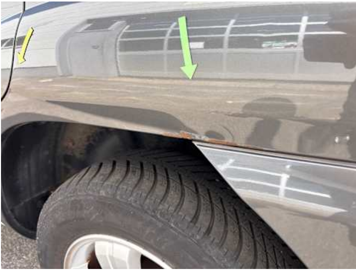
Seitenteil hinten links (Kratzer, Lackschaden, Delle, Rost)
