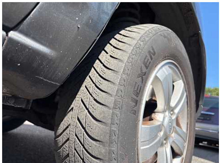
Rad (Ungleichmäßig abgefahren)
