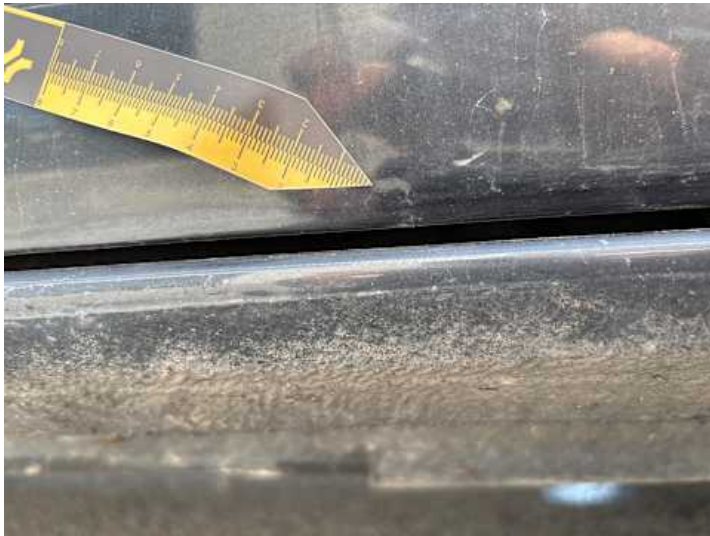
Beifahrertür (Delle, Rost)
