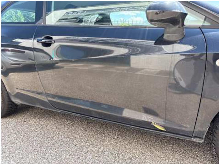
Beifahrertür (Delle, Rost)
