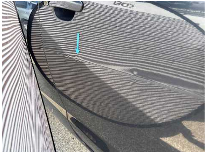
Beifahrtür (Delle, Rost)
