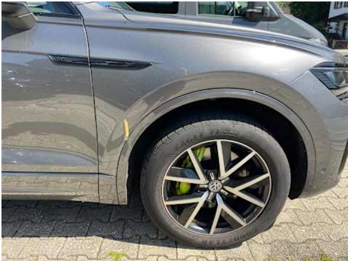
Kotflügel vorne rechts (Kratzer, Lackschaden)
