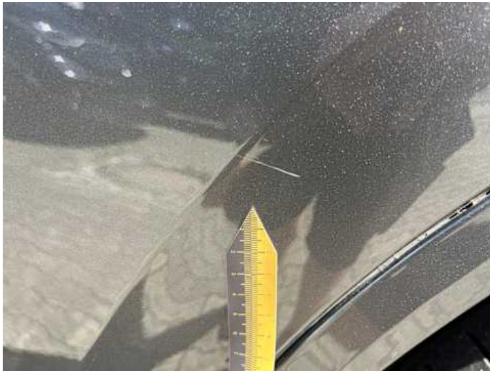
Kotflügel vorne rechts (Kratzer, Lackschaden)
